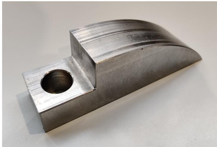
*Ilustración 36. Diseño final de los apoyos*
