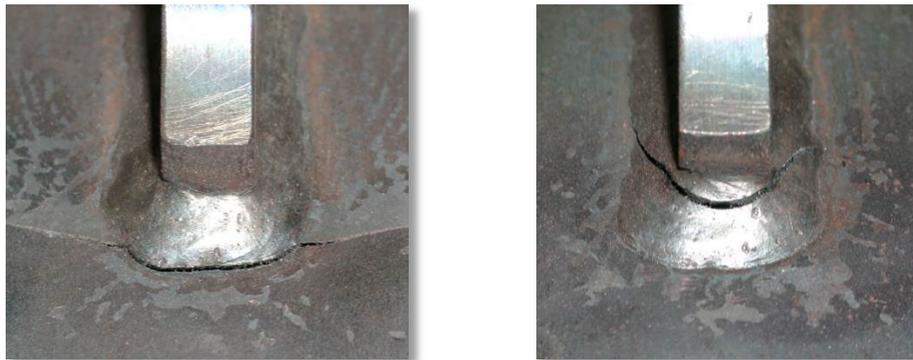
*Ilustración 8. Ejemplos de grieta en el pie (izq.) o en la raíz (dcha.) de la soldadura*
