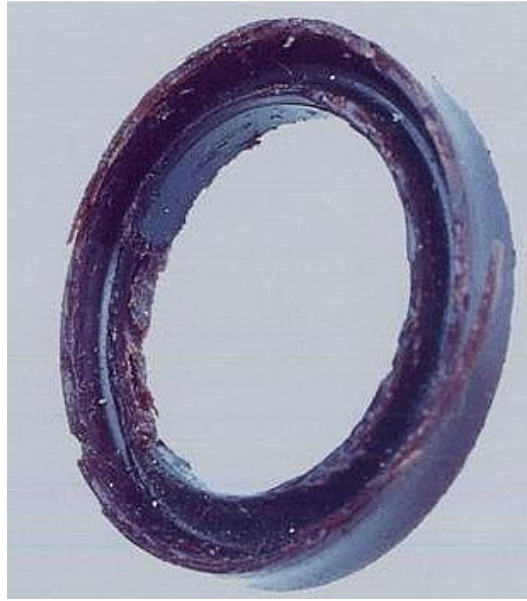
Ilustración 10. Daño de dieseling en un junta [7]
