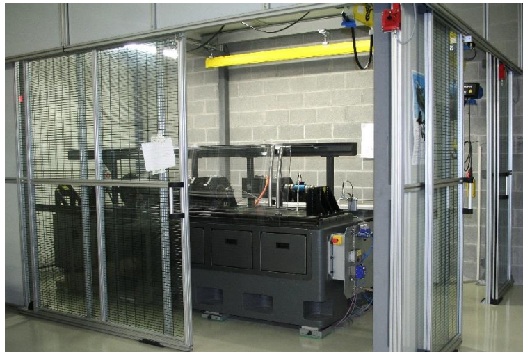
Ilustración 23. Cercado de seguridad de la TESSA
