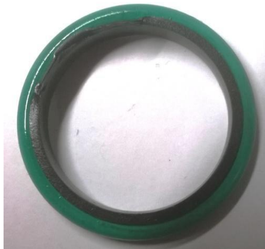
Ilustración 9. Fallo debido al montaje incorrecto (Fuente: Tekniker)
