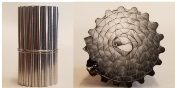
1.2 irudia. Kanal luzeko monolito metaliko baten egitura.
