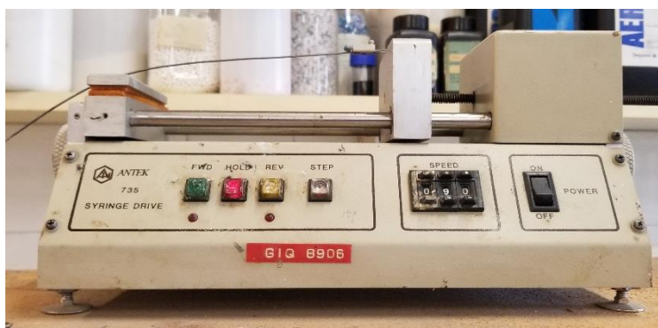
2.4 irudia. Estaldura prozesua egiteko erabiltzen den ekipoa.
