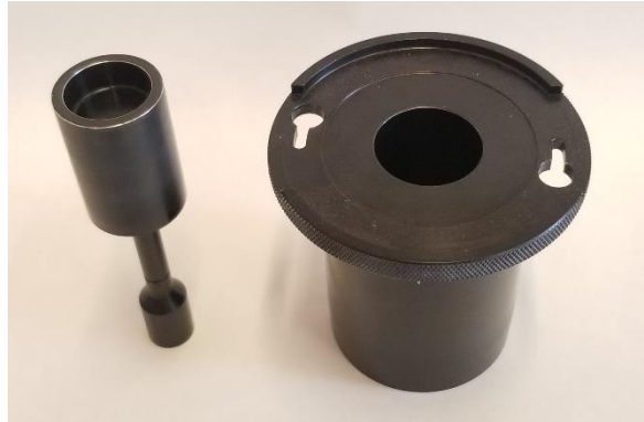
2.5 irudia. Likatasunaren neurketa egiteko erabilitako geometria zilindrikoa.
