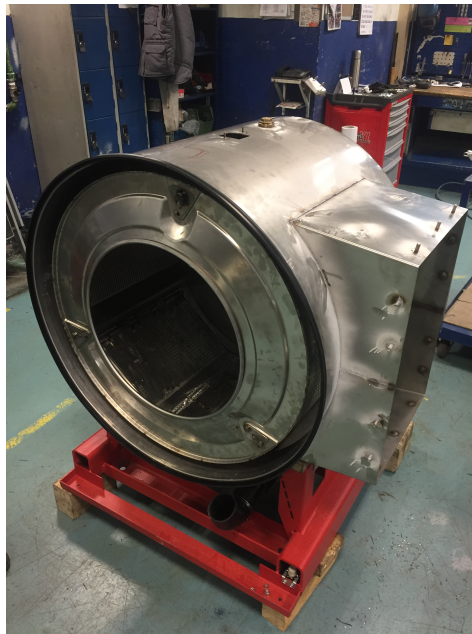
1.23 Irudia. Kuba eta danborra armazoiaren muntatuta.
