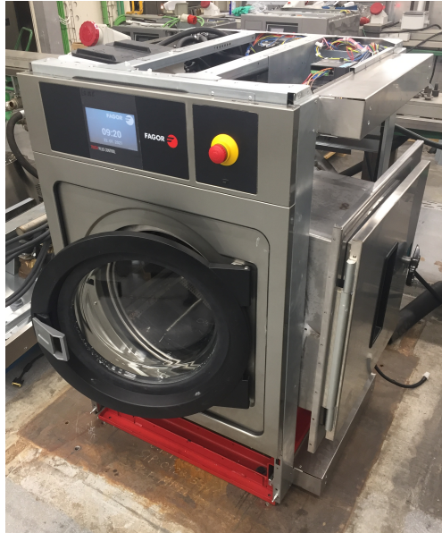
1.24 Irudia. MED90-18 Lehenengo prototipoa laborategiko postuan frogak egiteko prest.
