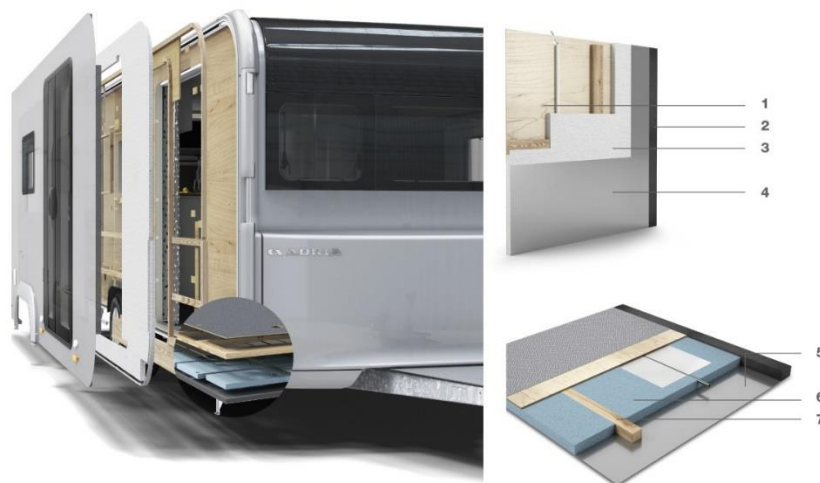
Ilustración 10. Descomposición de la envolvente del fabricante Adria
