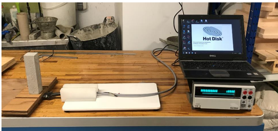
Ilustración 50. Ensayo de conductividad térmica
