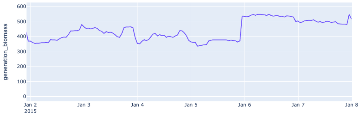
Figura 5: Ejemplo de aplicación del forward fill sobre instantes en los que faltaban datos de la variable generation biomass .
