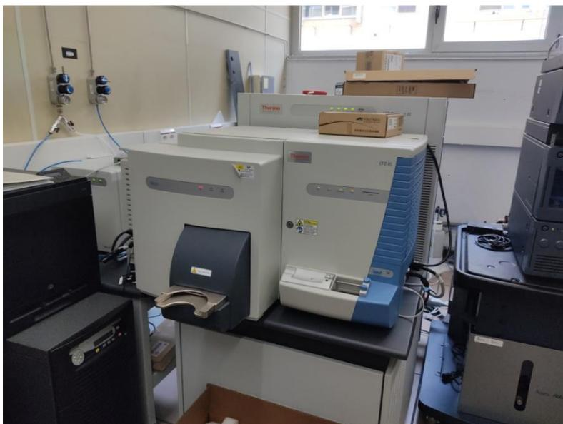
*Figura 11.- MALDI-LTQ-Orbitrap XL desarrollado por Thermo Fisher Scientific empleado, para la adquisición de datos.*
