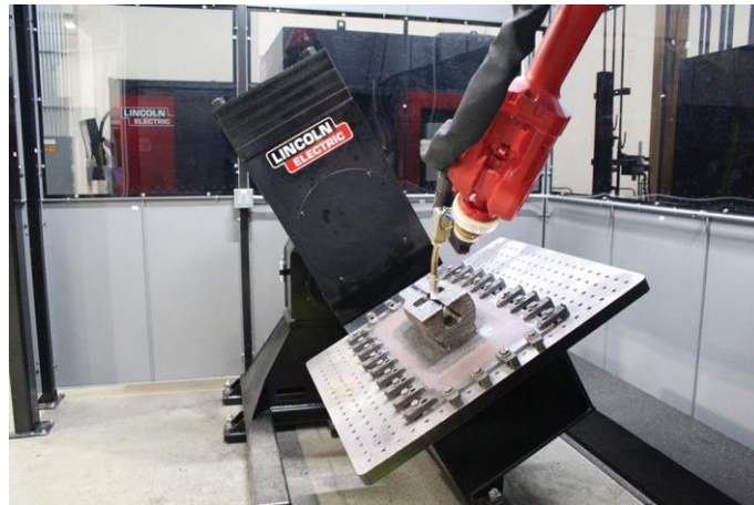
II-19. irudia. Lincoln Electric enpresaren sistema robot antropomorfiko batean oinarritua [Lincoln Electric Additive, 2021]
