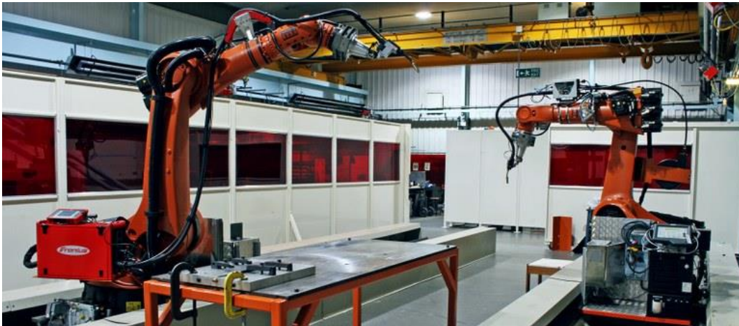
II-21. irudia. WAAM zelula robotikoa, GMAW prozesuan oinarritua, paraleloan lan egiten duten 2 robotekin produktibitatea handitzeko [WAAMMAT, 2021]
