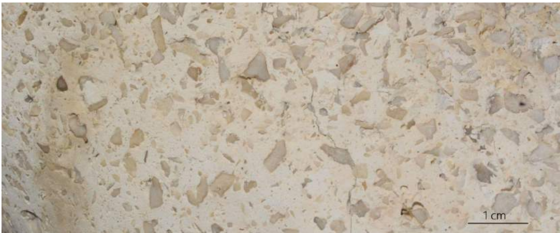
Figura 18. Lamiaren ataleko hormigoiaaren xehetasuna, higitutako zonaldea.
