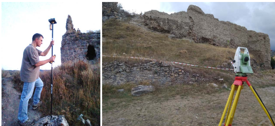
Fig. 4. Izquierda, momento de observación GNSS. Derecha, estacionamiento con estación total.
