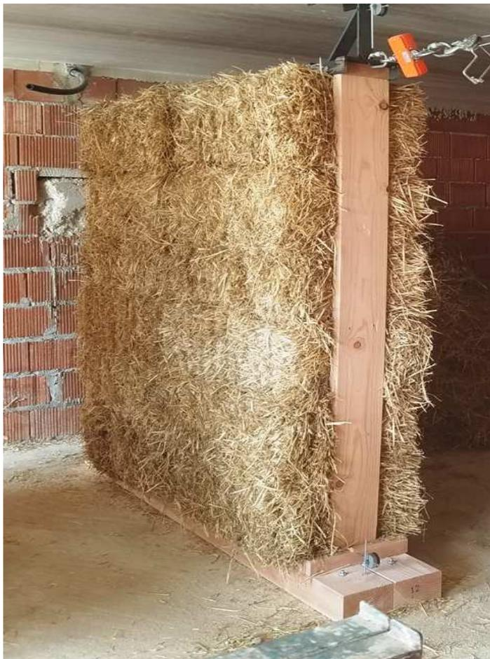
*Imagen 13: Módulo A. Bastidor relleno con fardos de paja.*
