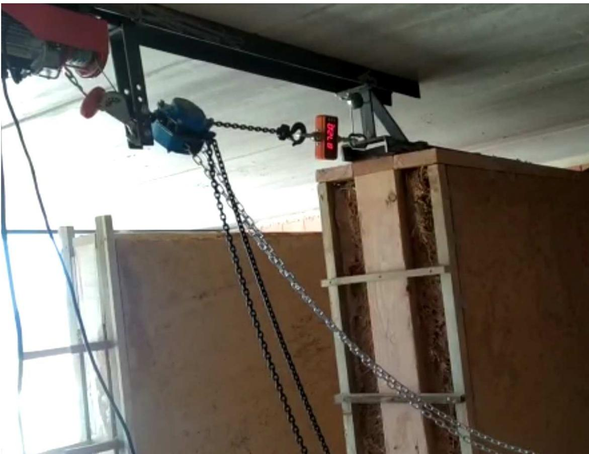
*Imagen 34:Modulo A, Carga 872Kg, deformación instantánea 22mm.*
