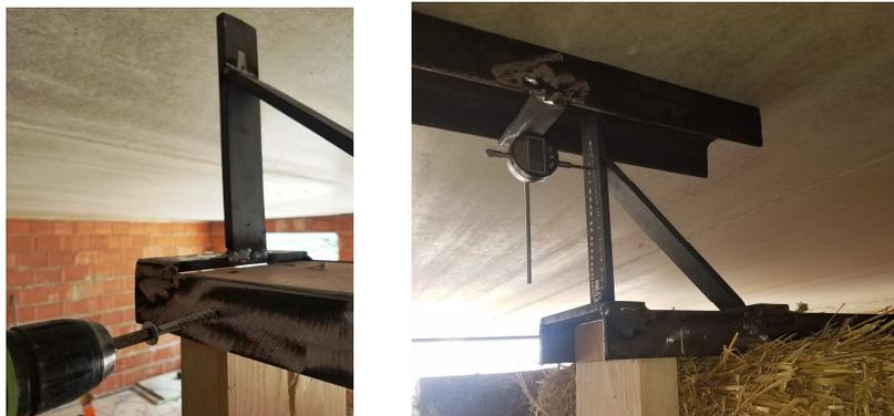
Imagen 17: Abrazadera de carga al testero superior del muro (Izquierda), Reloj comparador (derecha).
