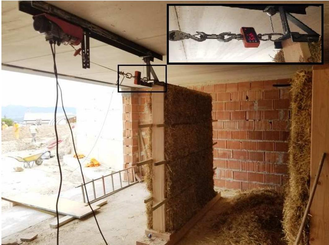
*Imagen 18: Dispositivo de carga en módulo B.*
