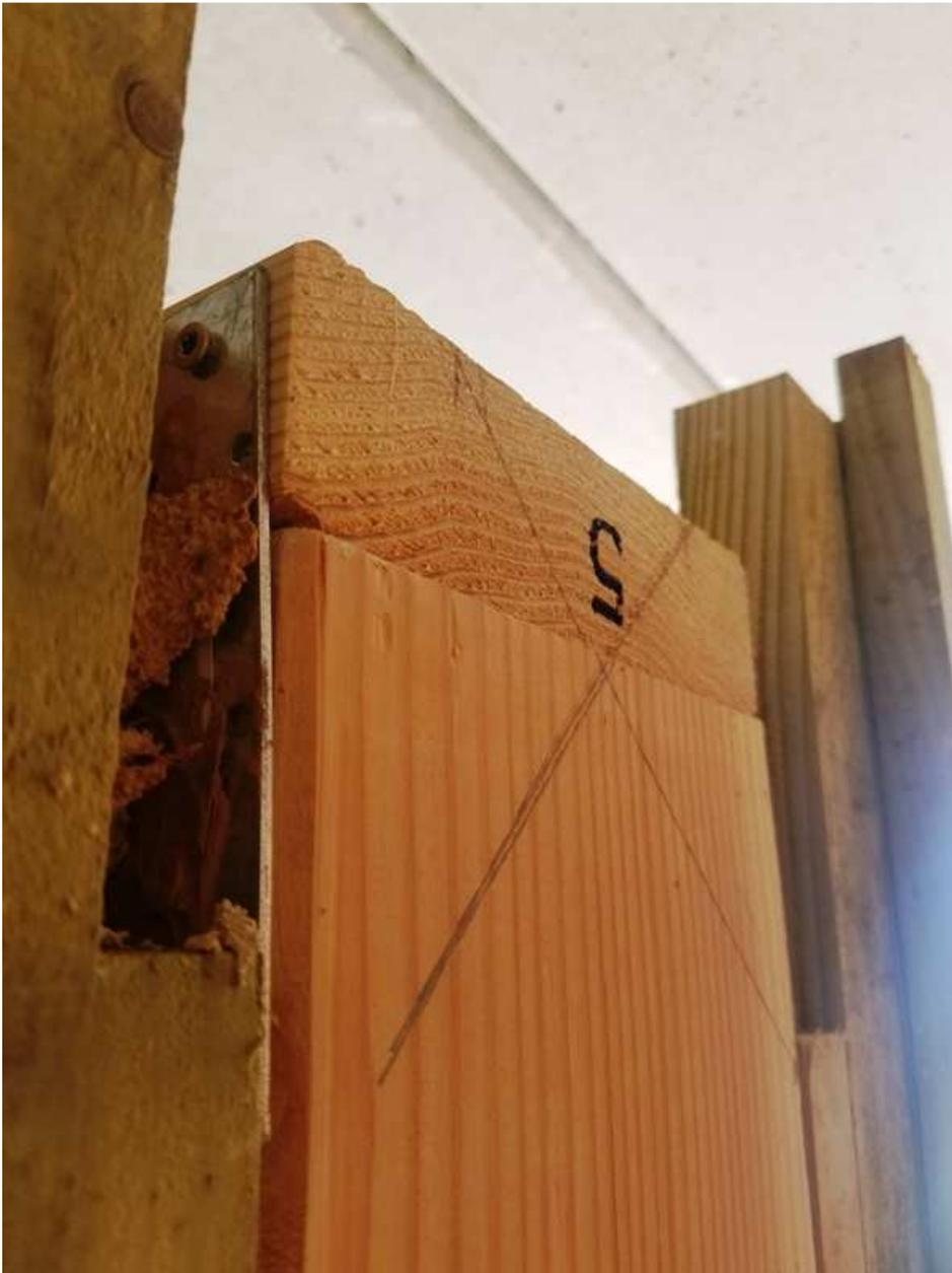
*Imagen 45: Chapa metálica girada por cortante entre testero y montante.*
