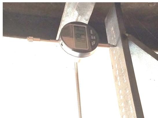
Imagen 31: Modulo A, deformación inicial en carga.
