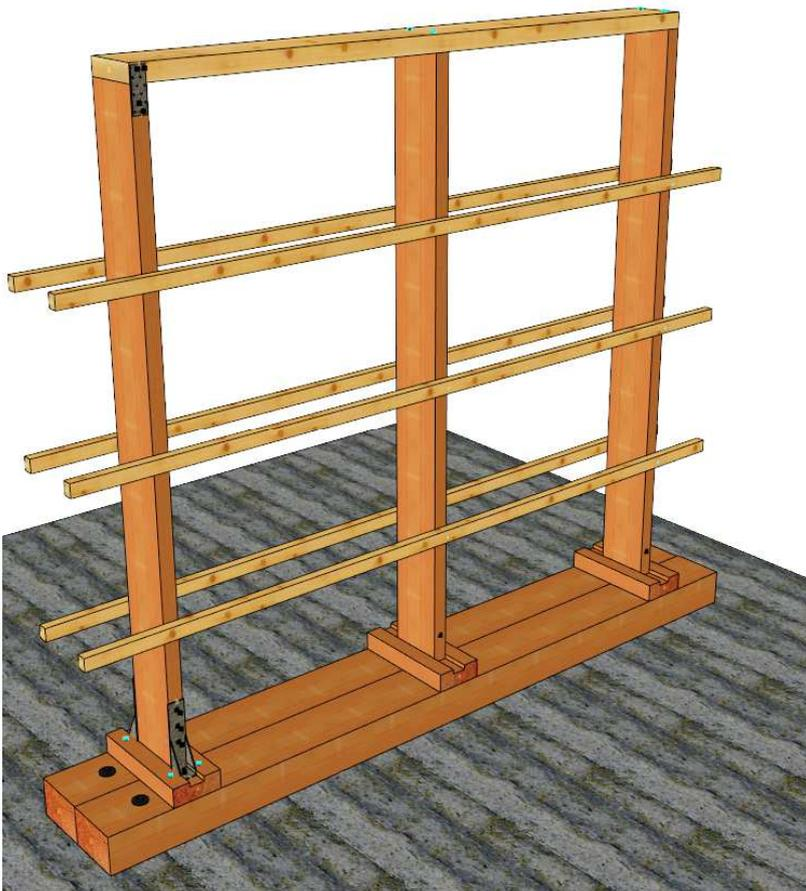
*Imagen 14: MODELO B, CUT modificado. Estructura de madera.*
