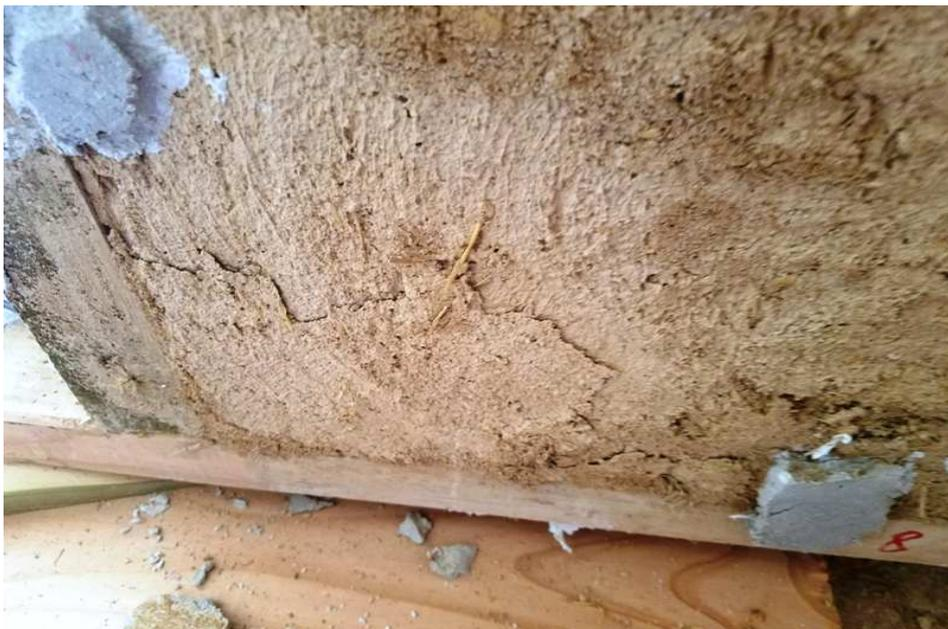
*Imagen 43: Zona inferior (aplastamiento) esquina bajo la aplicación de la tracción.*
