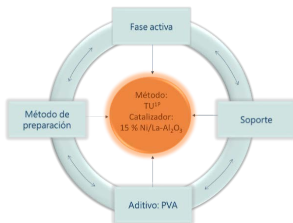
Figura 3.49. Esquema del proceso de selección del catalizador para la metanación de CO 2 .
