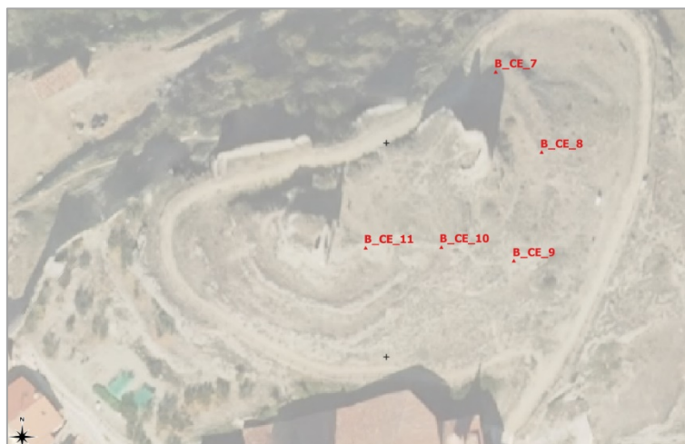
Fig.4. Distribución de los clavos utilizados como red de referencia sobre la ortoimagen de planta de del castillo de Enciso.
