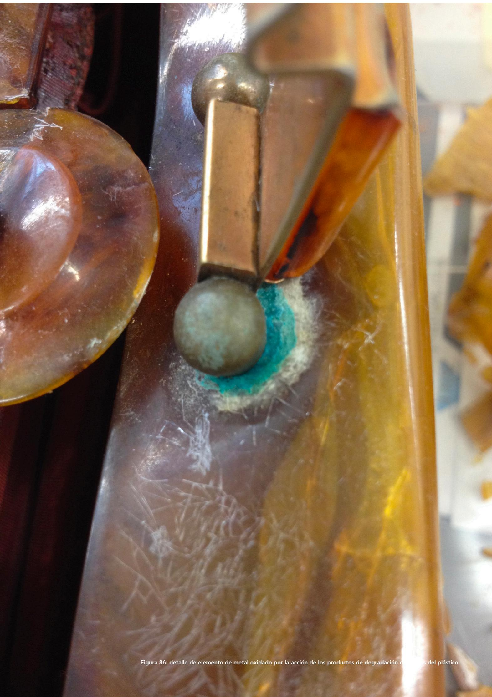
Figura 86: detalle de elemento de metal oxidado por la acción de los productos de degradación de los plásticos del plástico
