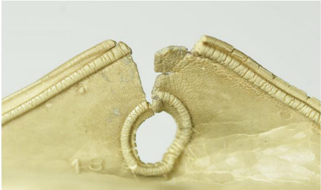
Figura 27: detalle de zona quebradiza en una botella de agua caliente hecha en caucho
