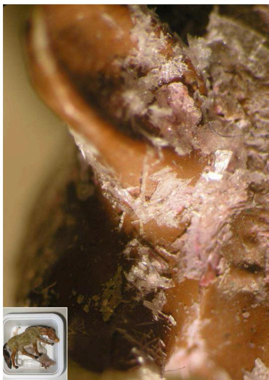
Figura 10: residuo sólido derivado de la exudación de plastificante del acetato de celulosa en el que está realizado el juguete, principios de la década de los sesenta
