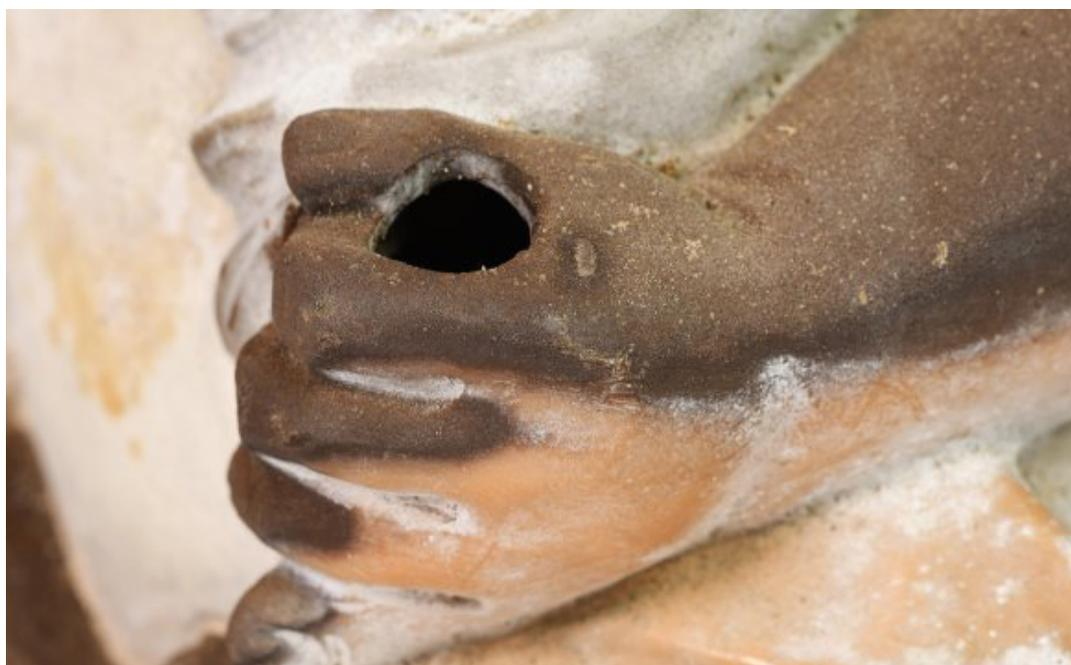
Figura 12: detalle del oscurecimiento de la mano de un gnomo de jardín de policloruro de vinilo por la acción de la luz
