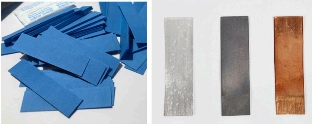
Figura 37: A-D Strip (izquierda) y cupones metálicos; plata, plomo y cobre (derecha)
