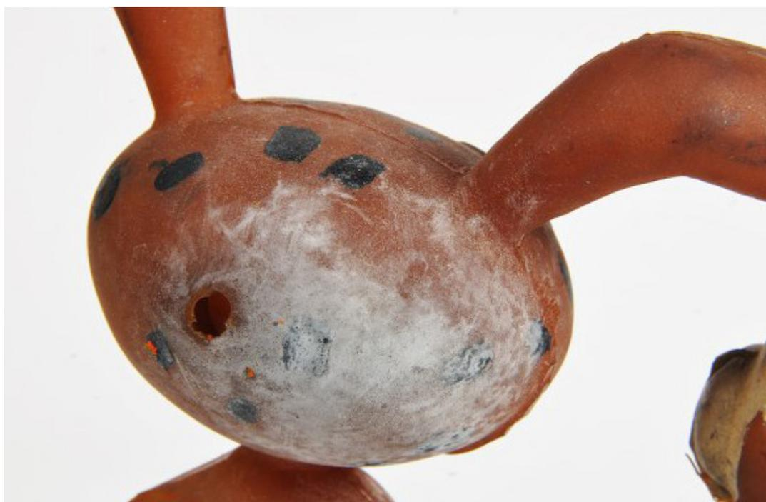
Figura 23: detalle de depósito blanquecino en la superficie de un Marsupilami de juguete hecho en PVC
