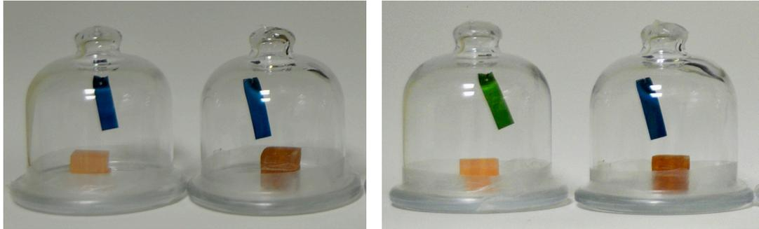
Figura 78: resultados de la medición de volátiles ácidos mediante A-D Strips en el caso de las muestras de poliéster correspondientes al CE-0 y CE-1 en contenedor mediano al inicio del ensayo (izq.) y tras cuatro semanas de exposición (dcha.), en los que se observa una relación directa entre el aumento del tiempo de exposición y el incremento en la concentración de volátiles.
