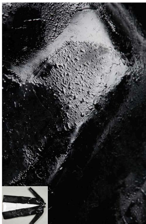
Figura 11: residuo líquido derivado de la exudación de los plastificantes de ftalato del policloruro de vinilo con el que está realizado el chubasquero
