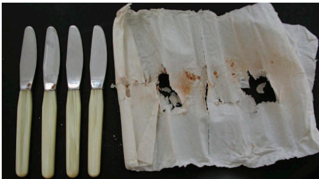
Figura 33: papel en estado de descomposición debido a las emisiones de ácido acético desprendidas por los mangos de estos cuchillos de los años cincuenta
