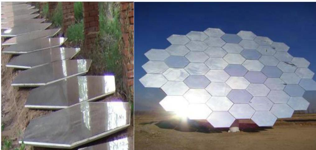
Figura 2.10 Superficie evaluada y heliostato con composición hexagonal (Xu et al., 2008)
