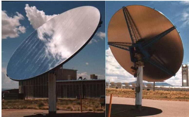
Figura 2.11 Prototipo del modelo de heliostato SM de segunda generación (Kolb et al., 2007)
