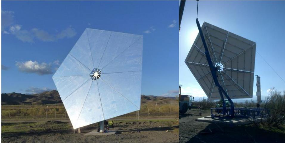
Figura 2.9 Heliostato pentagonal (Balz et al., 2016)
