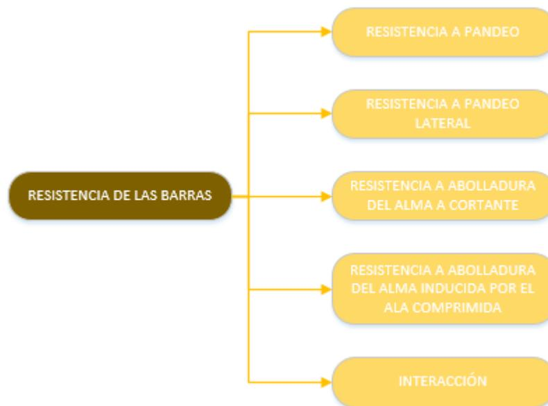
Ilustración 70 - Esquema resistencia de las barras (dintel)
