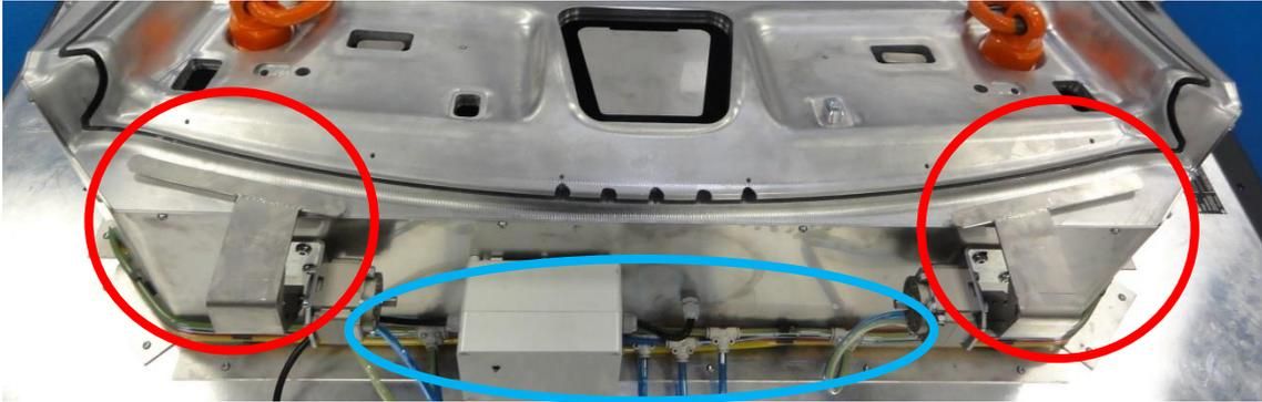
**Ilustración 9- Detalle pisadores (rojo) y sistemas neumático y eléctrico (azul).**
