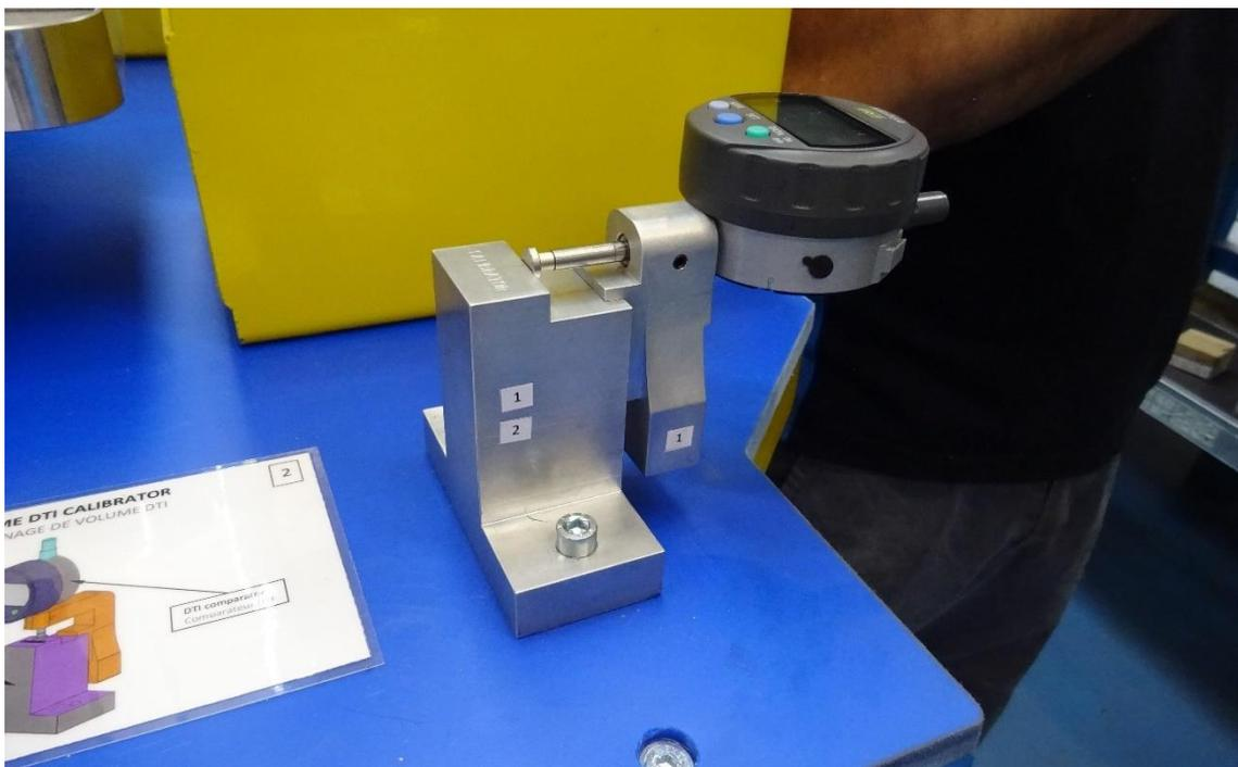
Ilustración 16- Reloj de longitud (1) sobre calibrador.
