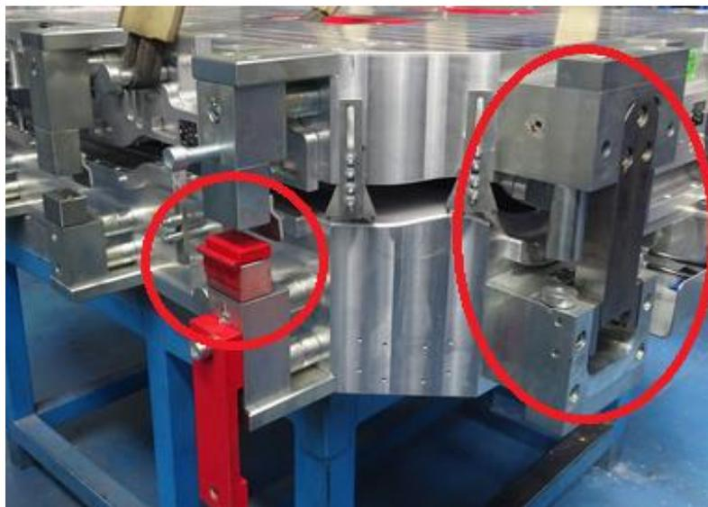
Ilustración 6- Detalle de cazoleta y sistema de guiado.
