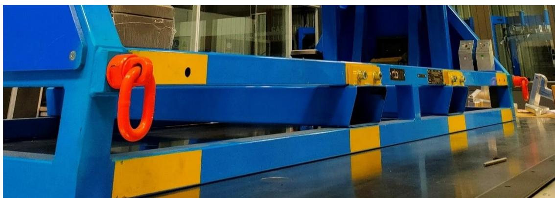
Ilustración 20- Detalle cáncamos y paso de palas.
