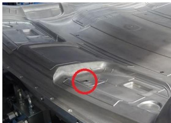
Ilustración 4- Detalle de punzón neumático.
