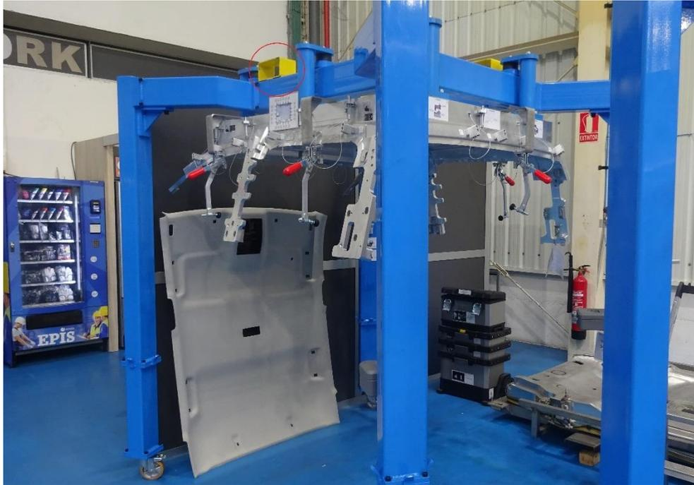
**Ilustración 21- Agarre bastidor HD04 para eslingas de tela.**
