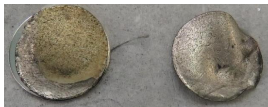
Figura 29. Imagen correspondiente al metal de litio y electrolito desmontado de la celda C3070 después del plating/stripping a distintas corrientes.
