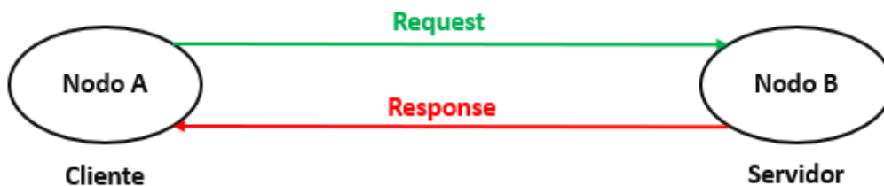
Figura 4.5 Estructura de una Comunicación por Servicio
