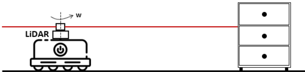
Figura 3.9 Ejemplo de AGV Equipado con Sensor LiDAR
