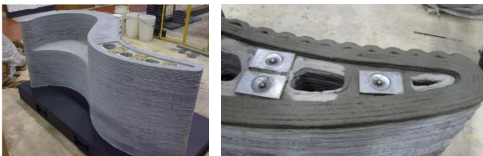
Figura 1.9. Piezas fabricadas mediante la tecnología de concrete printing [12].
