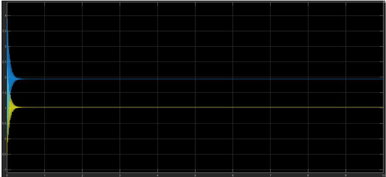
Figura 5-3: Valores de i_{ds} (amarillo) e i_{sq} (azul) para la simulación de la PMSG.
