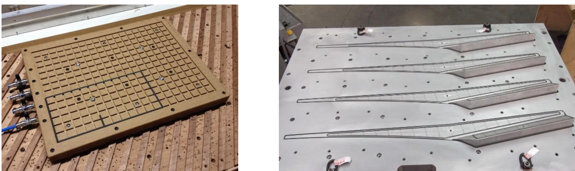
Figura III-22. Ejemplos de utillajes de vacío con distribución de ranuras en forma de cuadrícula.
