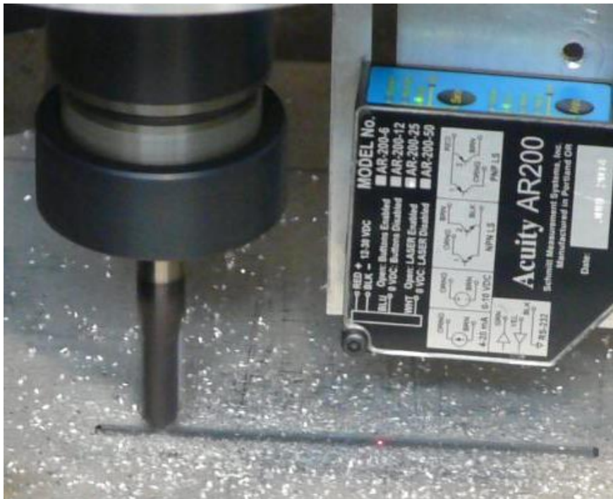
Figura V-8. Ensayos de medición de perfil con interferencia de viruta.
