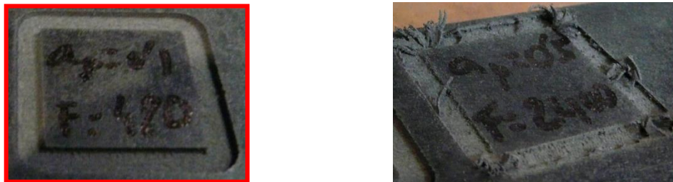
Figura III-21. Resultados del ranurado del elastómero en varias pasadas: 10 pasadas con a_p=0,1 mm y f=480 mm/min (izda) y 2 pasadas de a_p=0,5 mm y f=2400 mm/min (dcha).
