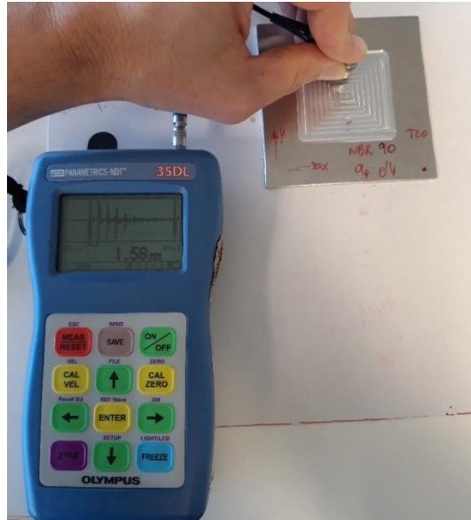
Figura III-11. Medición de espesor en caja mediante el medidor OLYMPUS Panametrics-NDT 35DL.
