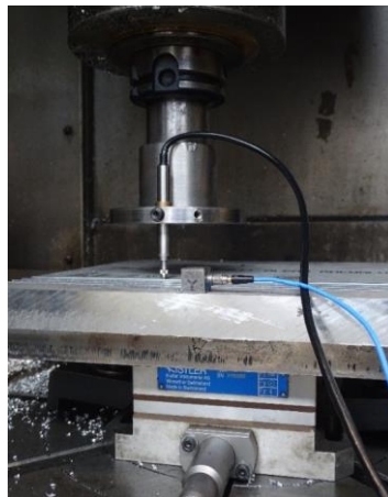
Figura IV-3. Medición de perfil de la ranura con LVDT.
