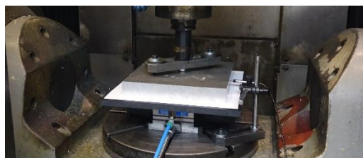
Figura III-39. Banco de ensayos de comportamiento del elastómero ante esfuerzos a cortadura teniendo en cuenta la pretensión por vacío.
