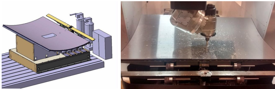
Figura V-21. Pruebas de fresado sobre el utillaje flexible pasivo con configuración de simple curvatura.
