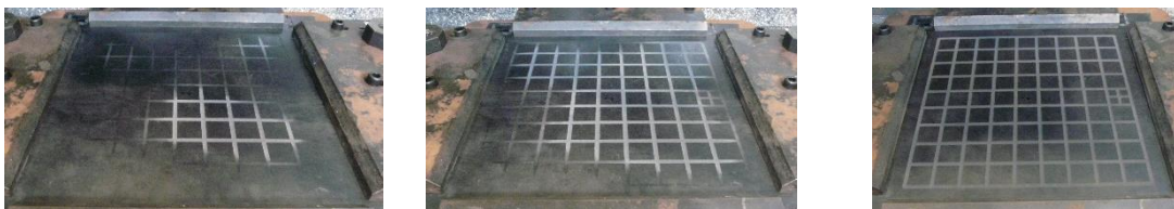
Figura V-31. Mecanizado de ranuras con una profundidad de 0,1 mm (izda.), 0,3 mm (centro) y 1mm (dcha.).
