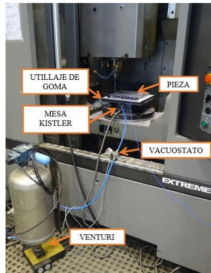
Figura III-24. Integración en máquina del utillaje basado en elastómero.
