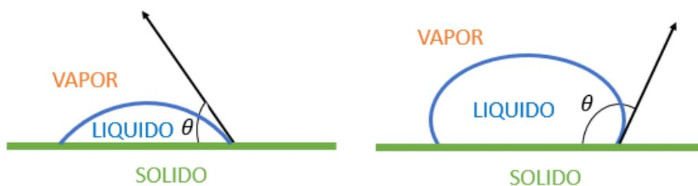
Figura 11: Ángulo de mojabilidad de una gota líquida sobre una superficie sólida.
