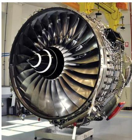
*Figura 19: Motor de avión fabricado con Al-MMC [69].*
