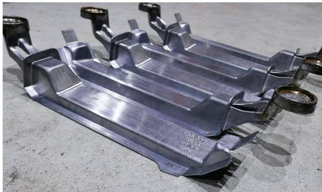
*Figura 18: Travesaño del asiento de un automóvil fabricado en la planta semi-industrial de TECNALIA. El material con el cual se han fabricado las piezas es: aleación AlSi10MnMg reforzada con partículas de Al<sub>2</sub>O<sub>3</sub>.*
