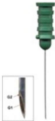
Figura 17. Electrodo de aguja concéntrico Nota: El electrodo activo (G1) se dispone concéntricamente al electrodo de referencia (G2)
