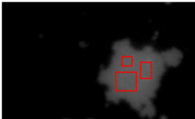
**Figura. 5.7. Parche para calibración.** Ejemplo de parche para calcular la constante de calibración. Los ROI seleccionados se muestran en rojo
