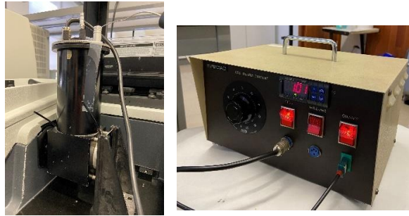
14. Irudia. IR -an akoplatutako berogailu ekipoa.
