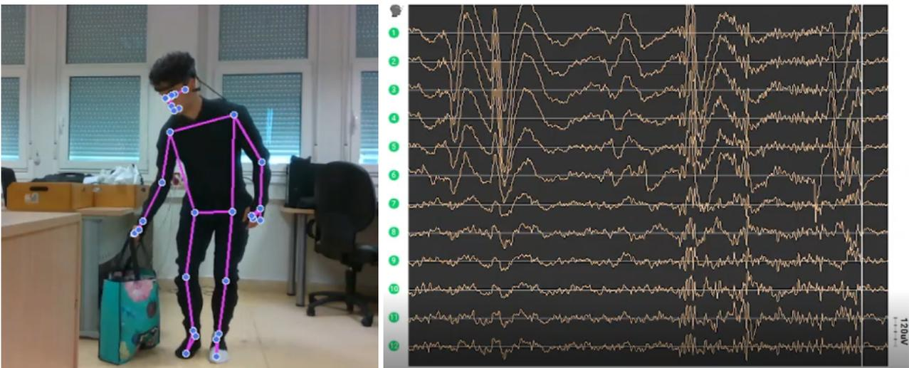
fig 41: señal EEG con ruido por movimiento de cabeza al recoger la bolsa pesada, prueba 1
