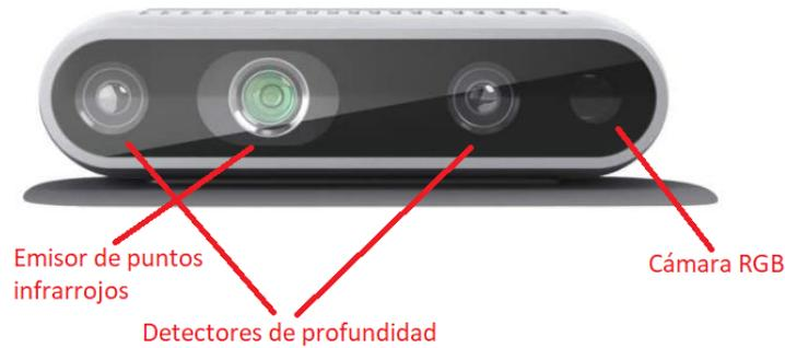
fig 3: imagen de las distintas partes del Intel d435
