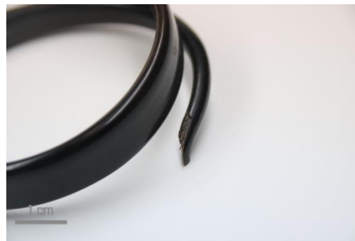
Figura 1 Pérdida de soporte.
