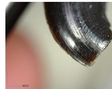
Figura 4 Imagen con Dino-Lite®. Pérdida de soporte y micro abrasiones.
