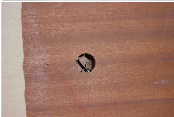
Figura 17. (abajo). Detalle del laminado y el interior hueco del soporte relleno de cartón
