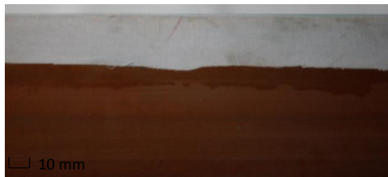
Figura 53 y 54. Detalles de las marcas brillantes dejadas por la aplicación de adhesivo sobre la madera
