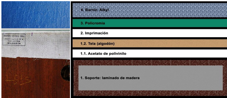
Figura 15. Representación gráfica de los estratos que componen la pintura
