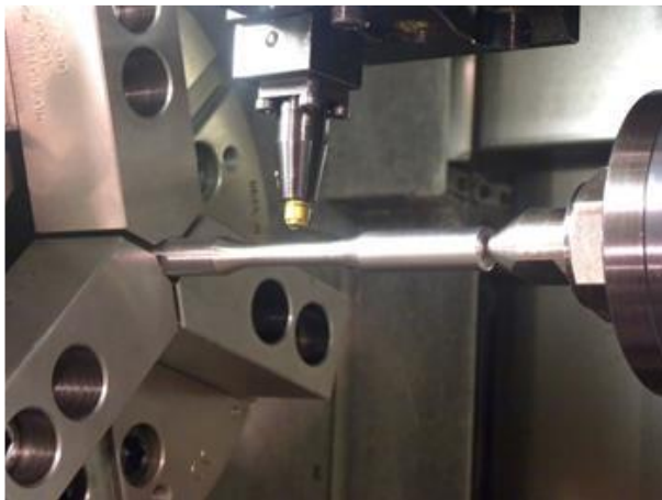
Figura 3-17. Aplicación de LPB en probetas para fatiga (A. Avilés, 2018).
