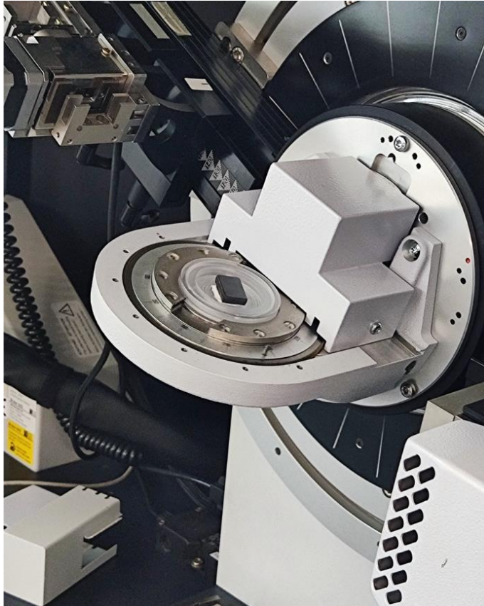
Figura 4-2. Set-up con muestra plana para difracción de alta resolución con BRUKER D8 Advance.
