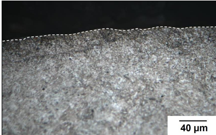
Figura 8-16. Metalografía de la probeta con SP C: 200%.
