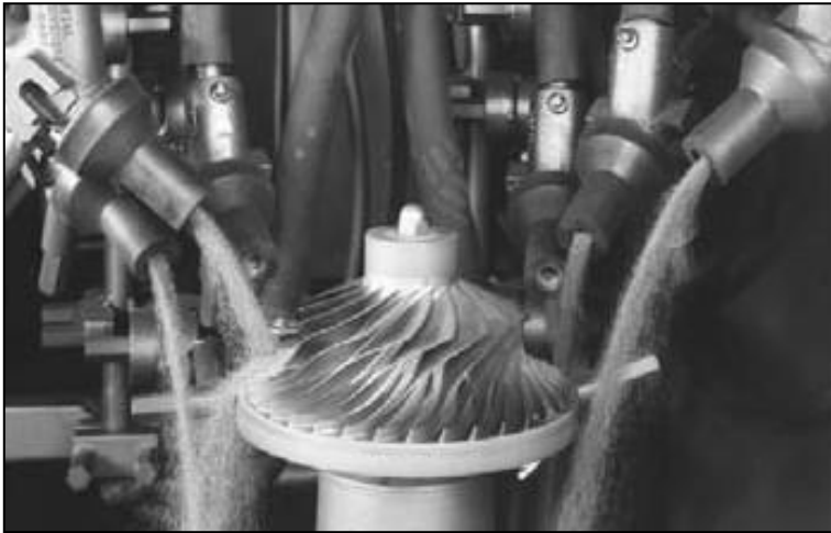
Figura 3-1. Ejemplo de aplicación de shot-peening (Totten et al., 2002).
