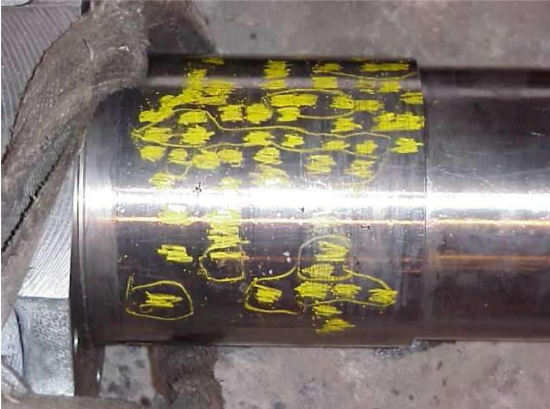
*Figura 2.6 Puntos de oxidación y arena en el extremo opuesto a la alimentación*
