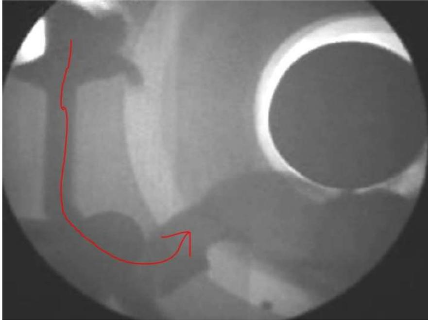
Figura 2.19 RX de llenado de aluminio en proceso Disamatik (cortesía fabricante)
