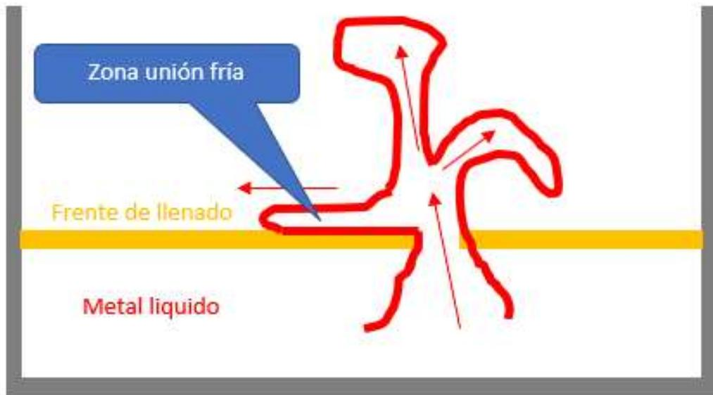
Figura 0.18 Típica unión fría en fundición
