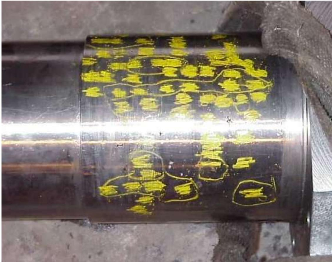
*Figura 3.32 Defectos en la pieza caso real b)*
