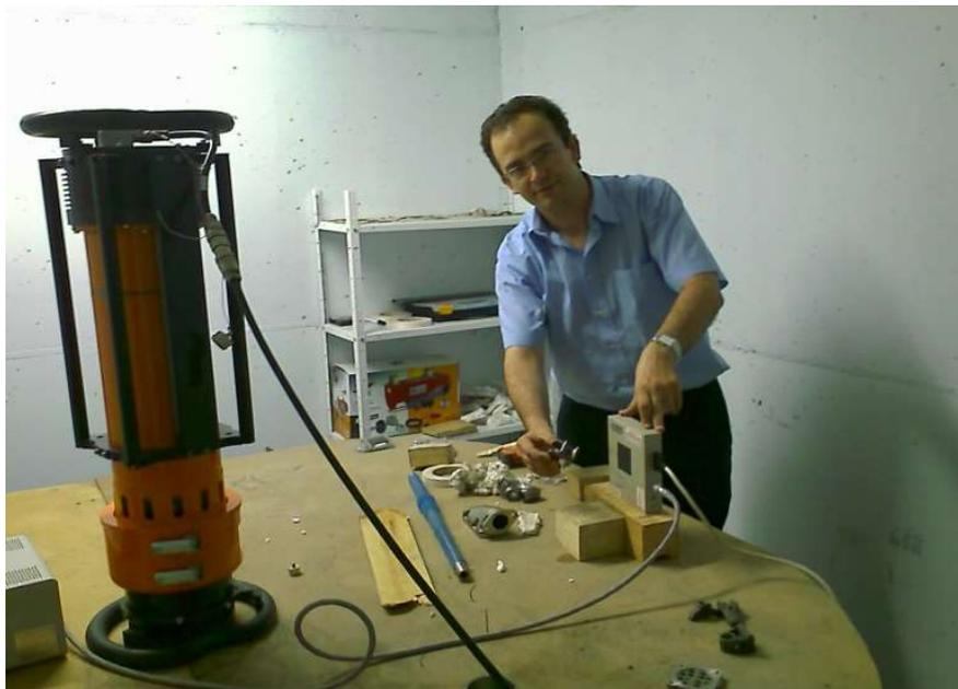
Figura 2.20 Tubo de RX conectado a un sensor CMOS para visualización digital
