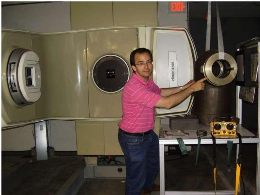
*Figura 2.22 Pruebas de radiografiado de acero con aceleradores médicos y sensores Cmos*
