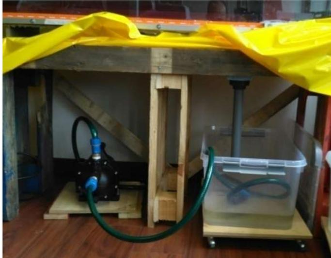
Figura 3.28 Sistema de recogida y bombeo de agua
