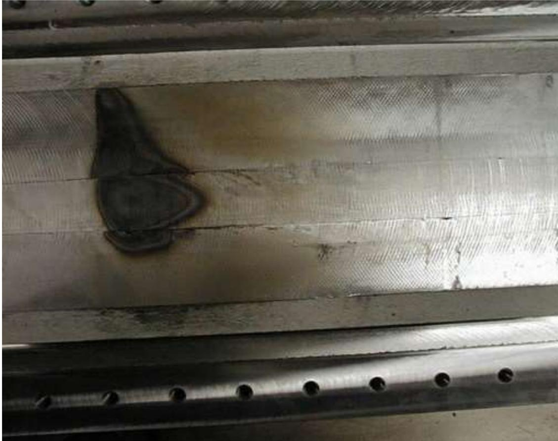
*Figura 3.35 Defecto en la pieza real caso c)*
