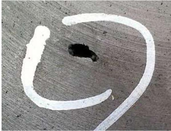
*Figura 2.18 Defectos de gas. Se puede observar cómo una esfera con algo de cola*
