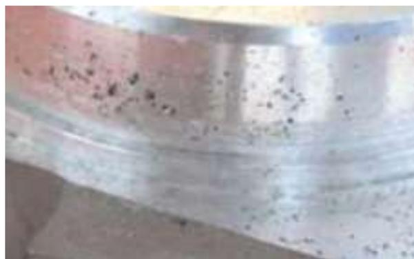
*Figura 2.17 Defectos de arena. Su geometría se puede asimilar a una esfera irregular*
