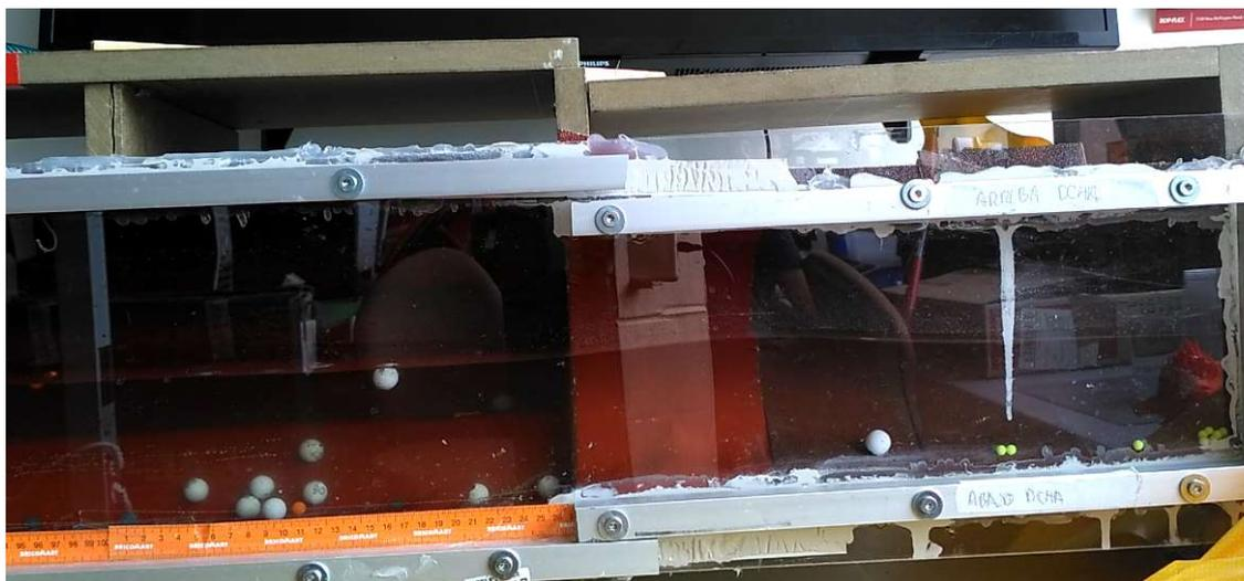
Figura 3.21 Esferas moviéndose en el fluido a medio llenado en el muñón
