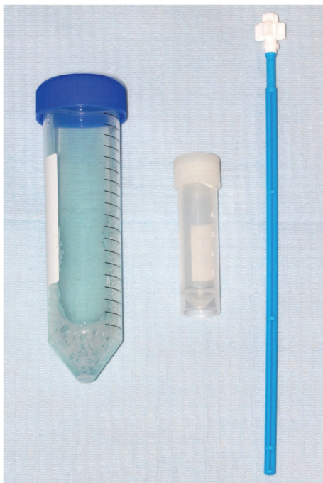
Figura 7. Recogida de muestras. Kit para la extracción del material genético: tubo Falcon con 50 mL de clorhexidina al 0,12%, tubo ependorf con 2,5mL de agua milli-Q y cepillo para el raspado citológico.
