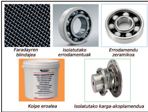
6. irudia. Ihes-korranteen aurkako soluzio industrialen adibideak. Ezkerrean, korrantea pasatzea eragozten duten soluzioak agertzen dira (isolatzaileak); eskuinean, berriz, ihes-korranteak lurrera edo txasira (eroaleak) bideratzen duten soluzioak. Irudia: egileek egina.
