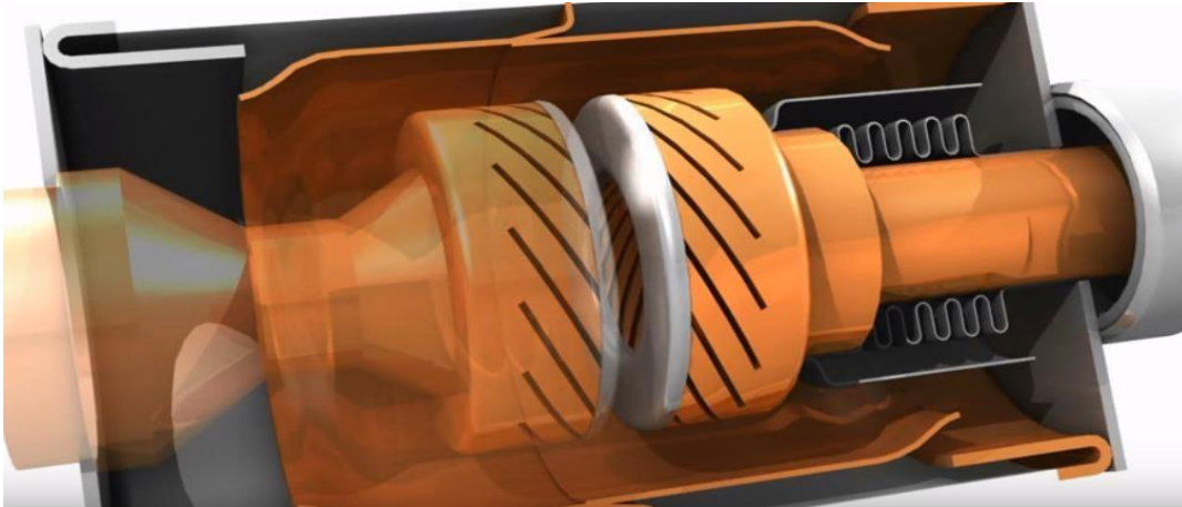
Figura 52. Ilustración de contacto del disyuntor de vacío.
