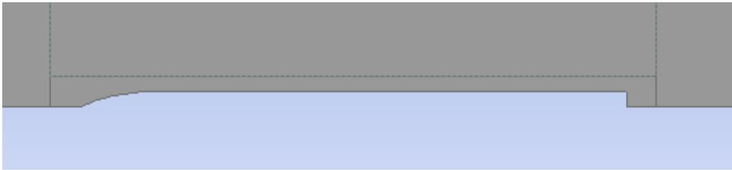
*Imagen 55.- Geometría de Von Karman para una longitud de 200 mm.*
