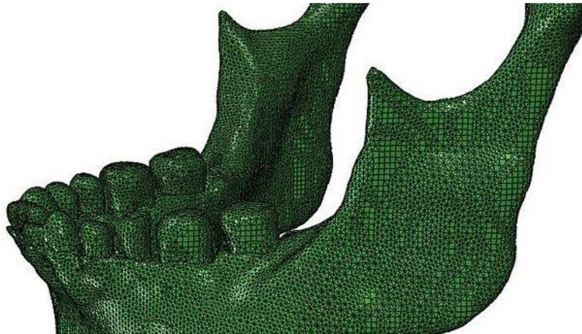
*Imagen 11.- Discretización de una mandíbula por elementos finitos*
