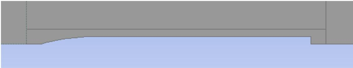
*Imagen 56.- Geometría de Von Karman para una longitud de 300 mm.*
