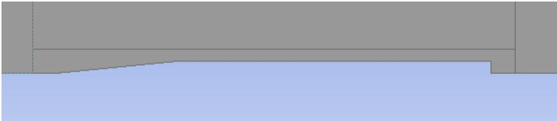
Imagen 63.- Geometría cónica para una longitud de 500 mm.
