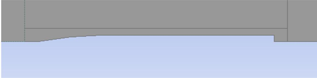
Imagen 58.- Geometría de Von Karman para una longitud de 500 mm.
