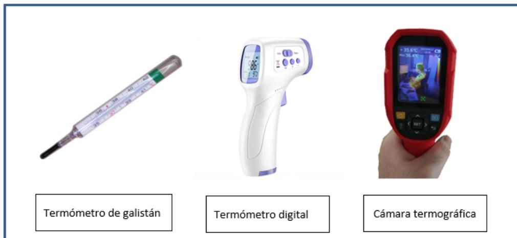
Figura 9. Sistemas de medición corporal portátil.
