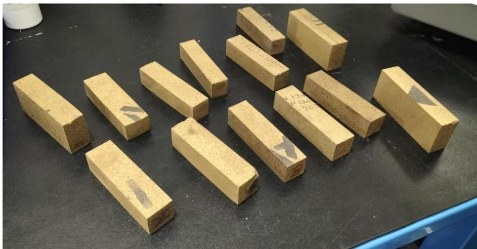
*Figura 41. Conjunto de probetas obtenidas de la muela WACL400MB1.*
