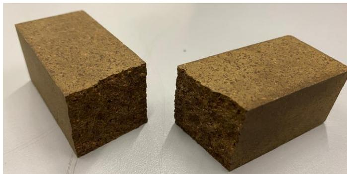
Figura 54. Fractura en una probeta axial.
