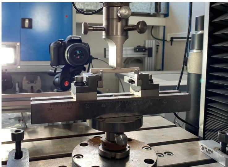
Figura 22. Setup del ensayo de 3 puntos para probetas de muela vítrea.
