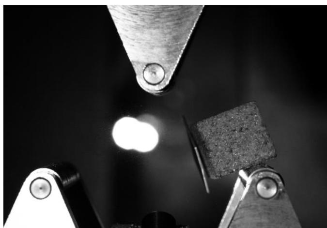
Figura 25. Rotura de probeta obtenida de muela vítrea
