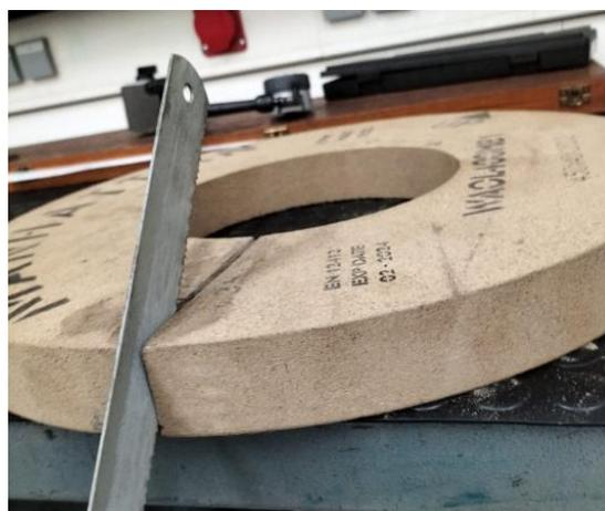
Figura 37. Corte de la muela WACL400MB1.
