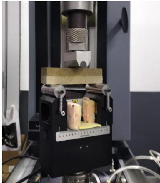
Figura 83. Ensayo sobre probeta longitudinal de los ensayos finales.
