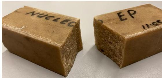
Figura 59. Fractura de probeta resinoides epoxi de Manhattan.
