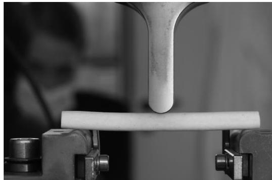
*Figura 96. Probeta de aglomerante sin pintar.*
