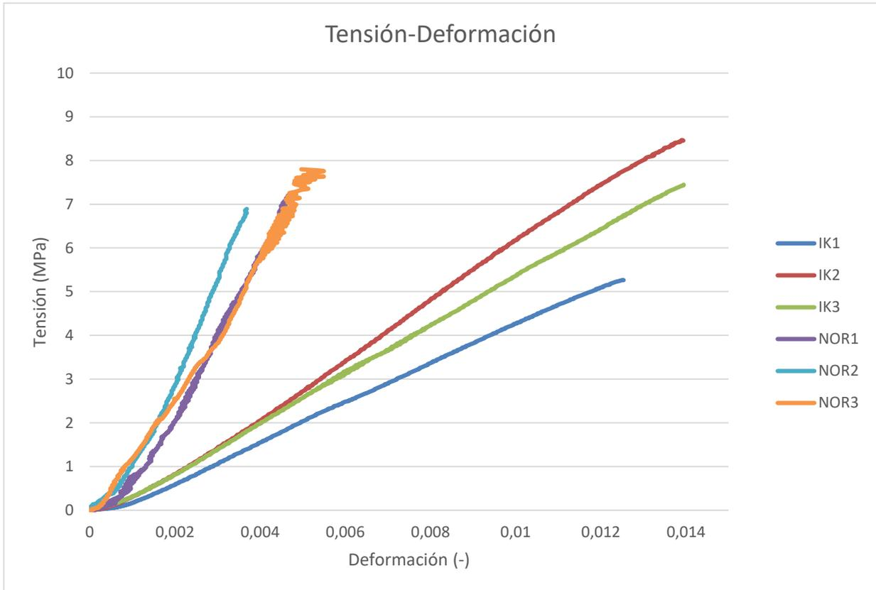
Figura 89. Curva Tensión-Deformación de las probetas de otros fabricantes de los ensayos finales.
