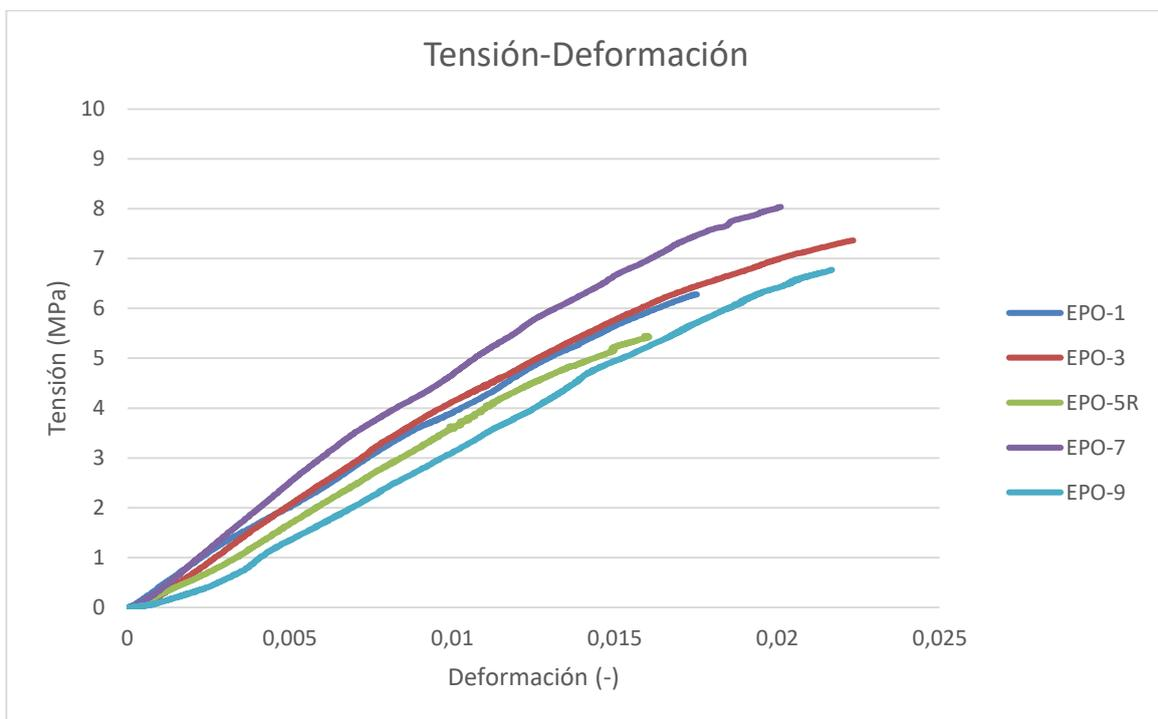
Figura 79. Curva Tensión-Deformación de las probetas longitudinales de epoxi de los ensayos finales.
