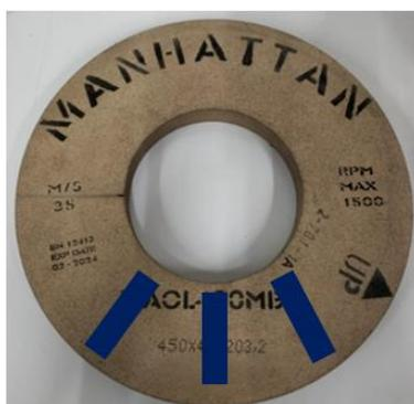
Figura 45. Sentido de fabricación de las probetas radiales.
