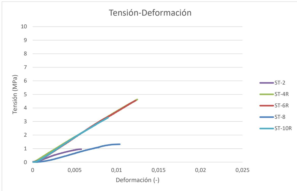
Figura 81. Curva Tensión-Deformación de las probetas longitudinales estándar de los ensayos finales.
