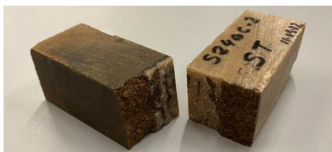
*Figura 72. Fractura de probeta mixta de Manhattan (III).*
