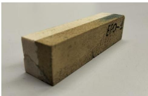
Figura 78. Probeta longitudinal de epoxi de los ensayos finales
