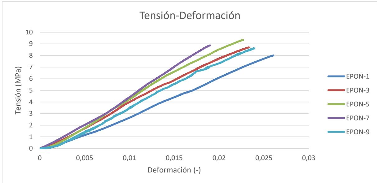
Figura 93. Comparativa de las tensiones de rotura entre resinas epoxi.
