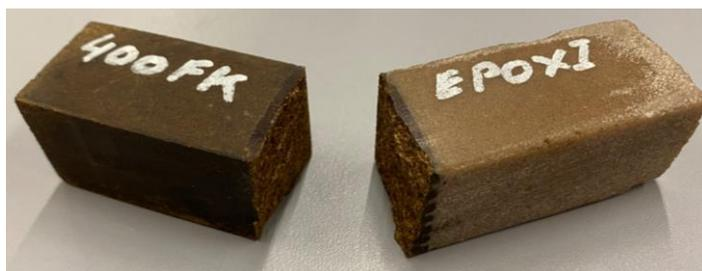
*Figura 70. Fractura de probeta mixta de Manhattan (I).*
