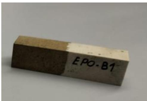
Figura 84. Probeta transversal de epoxi de los ensayos finales.
