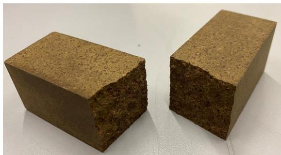
*Figura 47. Fractura de probeta radial.*
