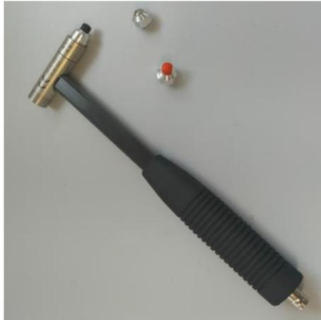
*Figura 107. Martillo excitador y cabezales.*
