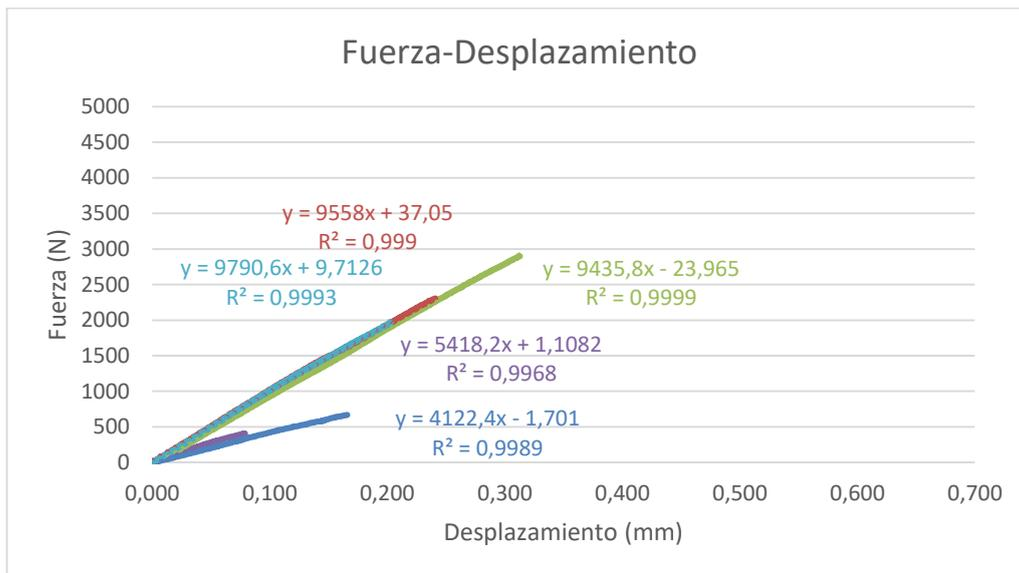
Figura 82. Zona lineal de la curva Fuerza-Desplazamiento de las probetas longitudinales estándar de los ensayos finales.
