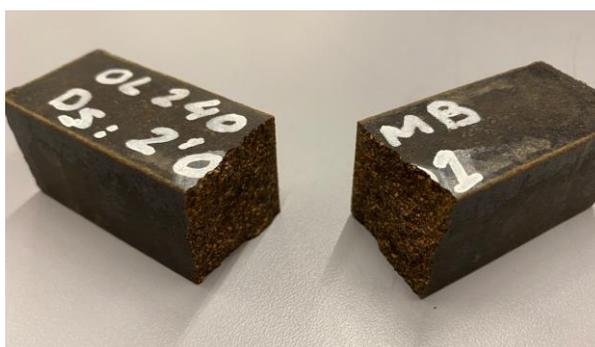
Figura 66. Fractura de la probeta de caucho de Manhattan.
