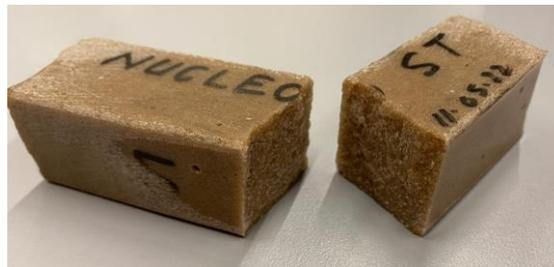
Figura 60. Fractura de probeta resinoides estándar de Manhattan.
