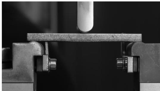
*Figura 97. Probeta de aglomerante pintada.*
