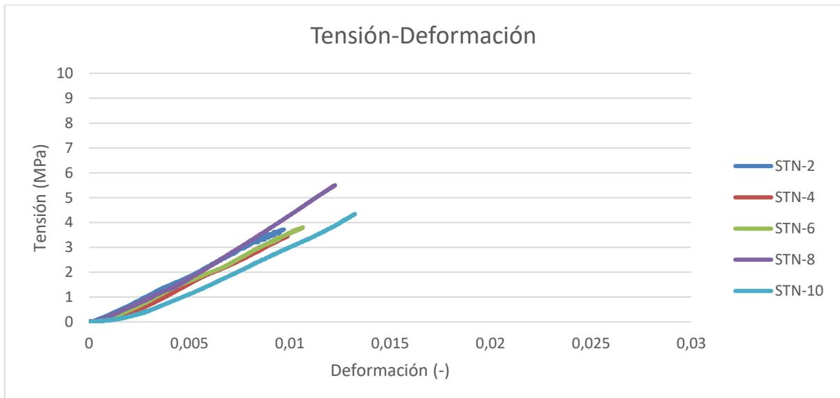
Figura 94. Comparativa de las tensiones de rotura entre resinas epoxi.
