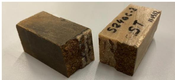
*Figura 92. Ejemplo de rotura de probeta con núcleo resinoides.*
