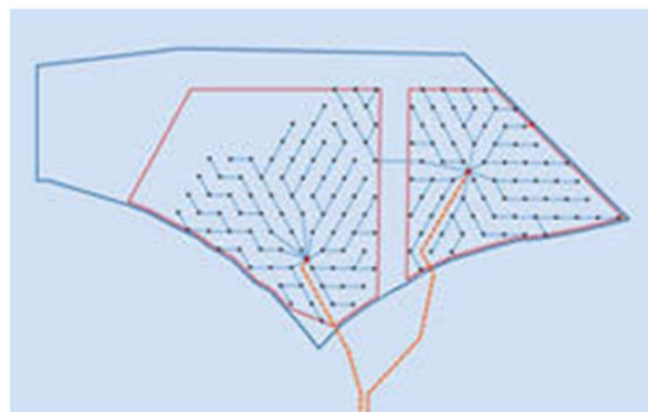
Figura 2.11: Sistema en dentrita. Parque eólico Gwynt-Y-Mor
