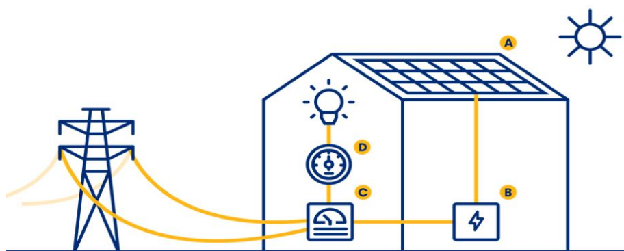
Figura 7. Instalación fotovoltaica de autoconsumo (Endef Solar Solutions, s.f.)
