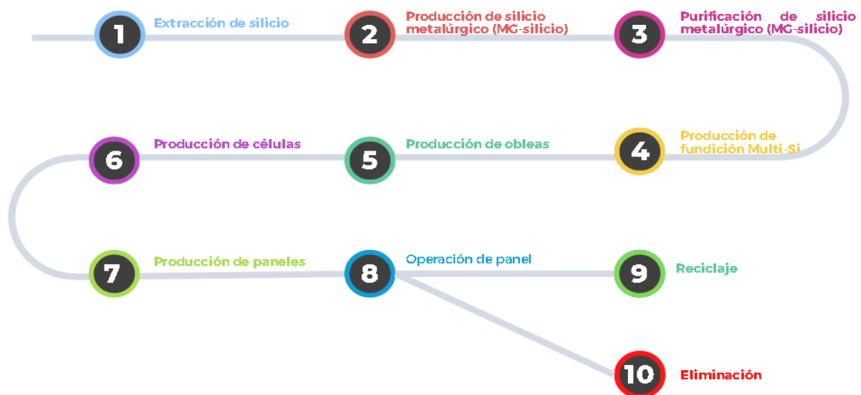
Figura 2. Resumen de los procesos de fabricación, operación, reciclaje y eliminación de un panel solar
