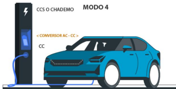
Figura 18. Modo de carga 4 CHAdeMO
