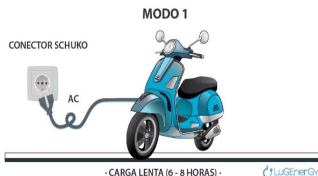
Figura 12. Modo de recarga 1 mediante conectores Schuko [41]
