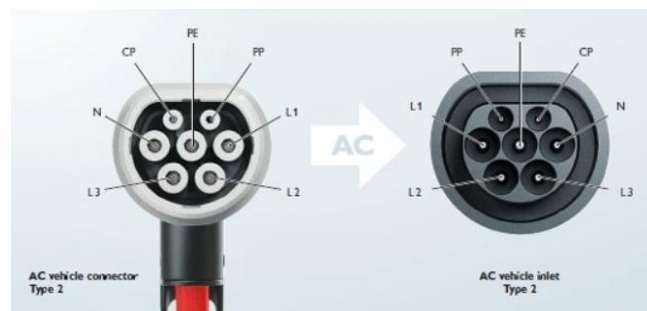
Figura 17. Esquema conector Mennekes [45]
