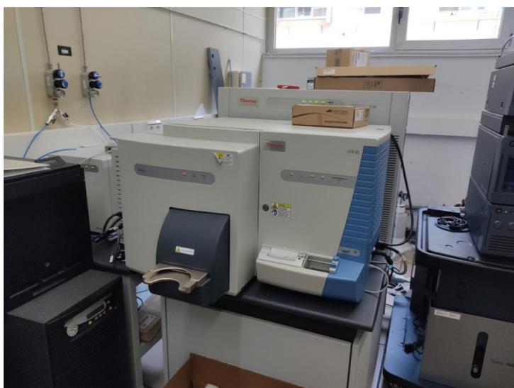
*Figura 9.- MALDI-LTQ-Orbitrap XL (Thermo Fisher Scientific) empleado para la adquisición de datos.*
