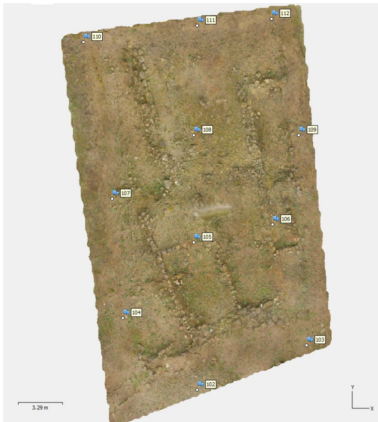
Fig. 17. Distribución del apoyo fotogramétrico en el sector 1Norte en 2022.
