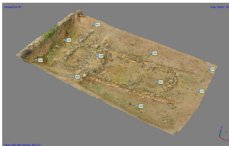
Figura 13.- Ubicación de los puntos de apoyo en el modelo 3D texturizado del sector 3 - 2022.
