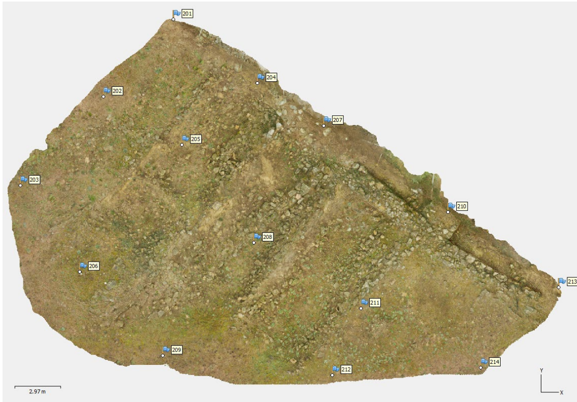
Fig. 18. Distribución del apoyo fotogramétrico en el sector 2 en 2022.
