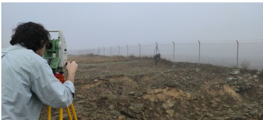
Figura 2.- Orientación de la estación total mediante la red de referencia de 2011.
