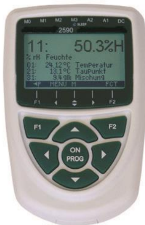
Figura 10 Adquisidor Ahlborn Almemo 2590
