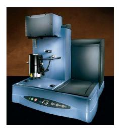
Figure 9 : TGA TA Instruments Q50
