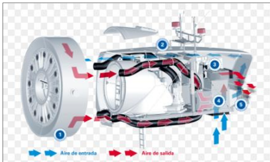
Ilustración 11:Sistema de refrigeración.
