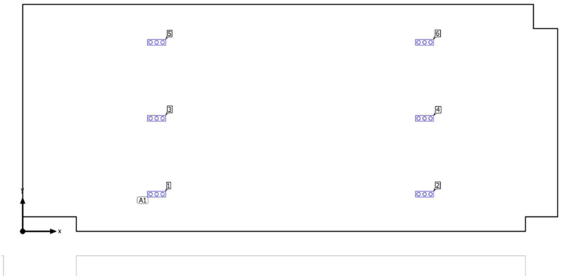
Figura 17: Disposición de luminarias de la sala de control 1 del edificio C.
