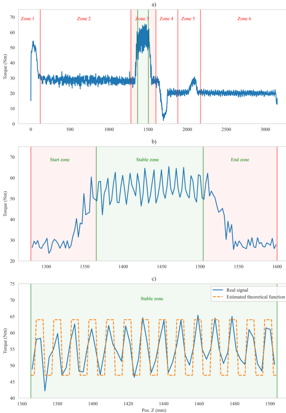
Ilustración 19: a) Zonas de la señal de Par de un brochado. b) Zonas de la señal de par en la Zona 3. c) Diferencia entre la señal de par y una estimación de la fuerza de corte teórica en la Zona estable.
