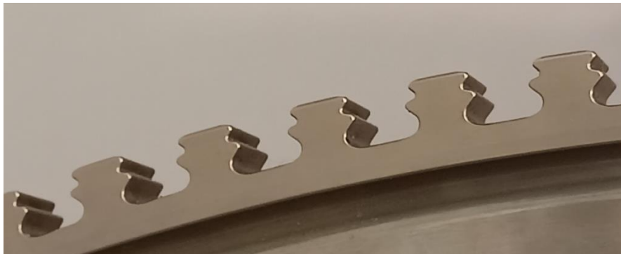
Ilustración 12: Forma de la ranura Firtree.
