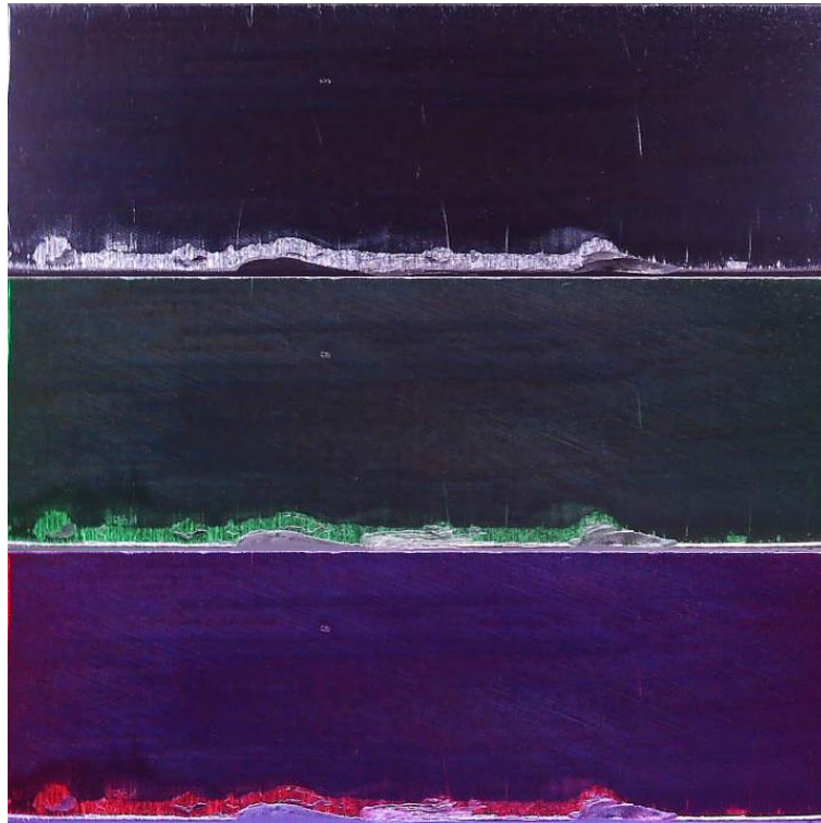
Ilustración 43: Diferentes configuraciones de luz que destacan el desgaste de los dientes de las brochas.
