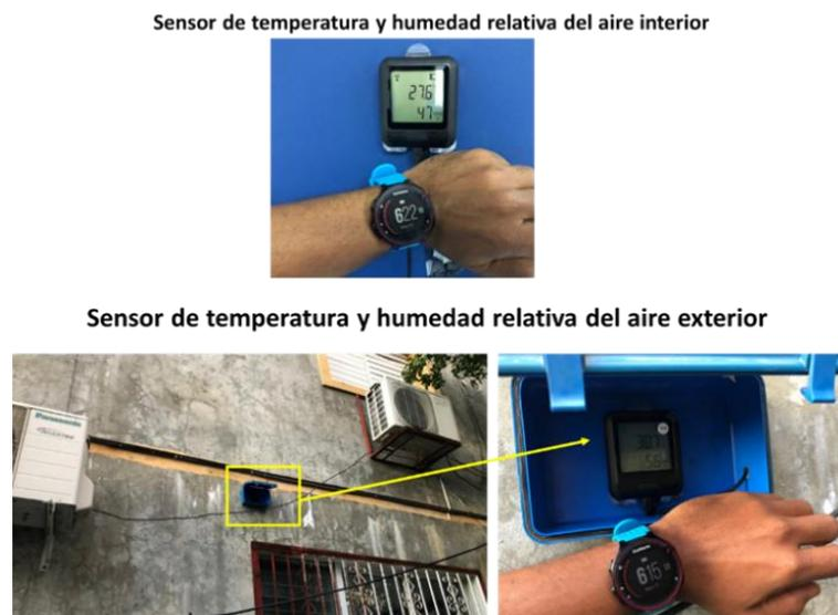
Figura 35: Vista de los sensores de temperatura y humedad relativa tanto del interior como el exterior del edificio tipo en la zona C, San José de Ocoa
