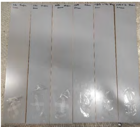
Figura 69. Prueba cross cut.
