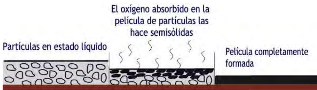
Figura 3. Esquema de secado por oxidación.
