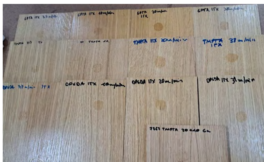
Figura 44. Prueba de dobles enlaces residuales. (de arriba abajo G-3, G-1 y G-2; de izq. A drcha. 3,7; 10; 20; 38 m/min)
