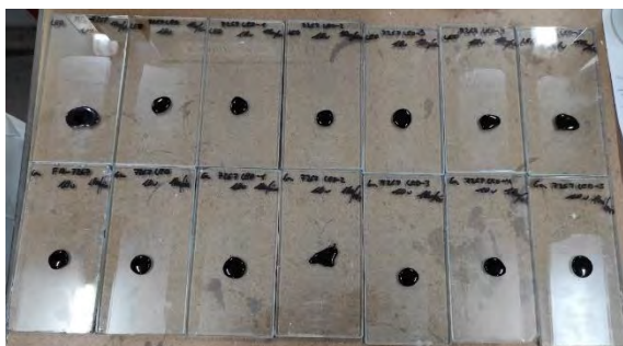
Figura 29. Inicio de prueba de dobles enlaces residuales.
