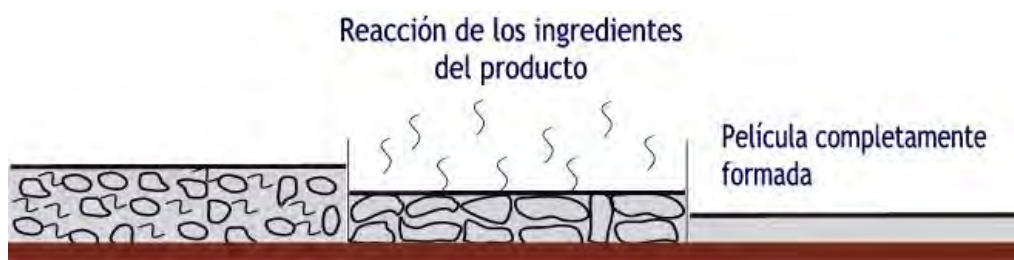
Figura 4. Esquema de curado por polimerización.
