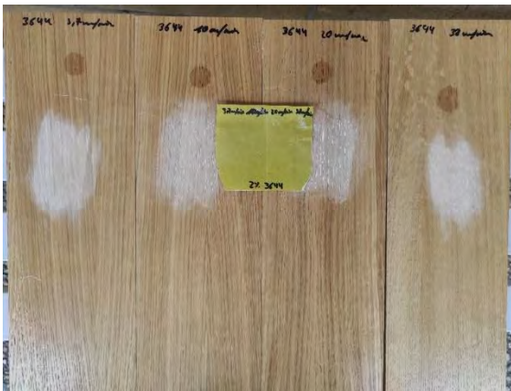
Figura 61. Lijado de H-4 con un 2 % de Esacure 3644 y velocidad de curado de 10, 20 y 38 m/min.
