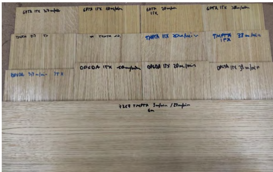
Figura 43. Aplicaciones en madera de los fondos F-1(abajo), G-1, G-2 y G-3 a diferentes velocidades de curado. (izq. a drcha.: 3,7; 10; 20 y 38 m/min.
