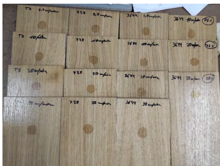
Figura 53. prueba de dobles enlaces residuales. (de izq. a drcha. TX, BL-728, 3644 y 3644 curado a intensidades de 75 % y 50 %. (de arriba abajo velocidades de curado de 3,7; 10; 20; 38 m/min)
