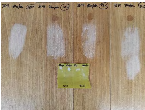
Figura 55. Lijado de H-4 a intensidad de 75 % y 50 % y velocidad de curado de 10 y 20 m/min.
