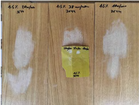
Figura 59. Lijado de H-4 con un 1,5 % de Esacure 3644 y velocidad de curado de 10, 20 y 38 m/min.
