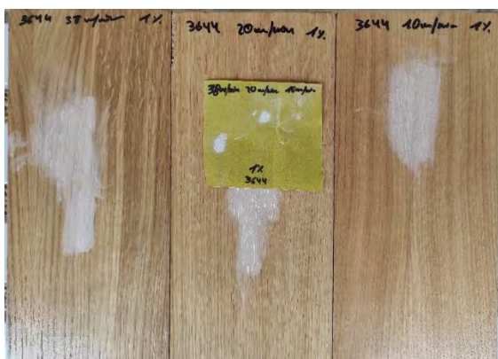
Figura 57. Lijado de H-4 con un 1 % de Esacure 3644 y velocidad de curado de 10, 20 y 38 m/min.
