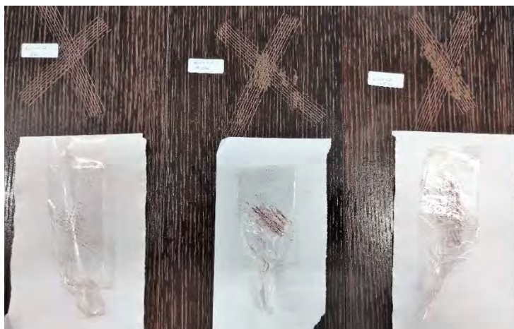
Figura 38. Desprendimientos del fondo. (Ga, Hg, LED de izquierda a derecha)
