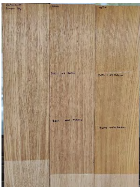
Figura 65. Curados. (de izq. a drcha.) F-ref. (Hg), H-4 (3644) (LED) y H-2 (DETX)(LED) con blanqueador óptico 0,3-0,6 %. (H-4 y H-2)
