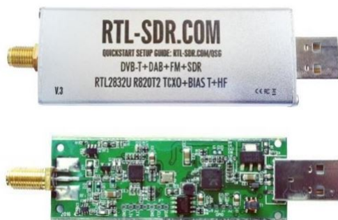
Figura 5.31: Receptor RTL-SDR Blog V3 usado en el diseño [RTLc].
