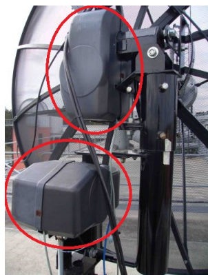
Figura 5.9: Ejemplo de rotor utilizado en [Lin].
