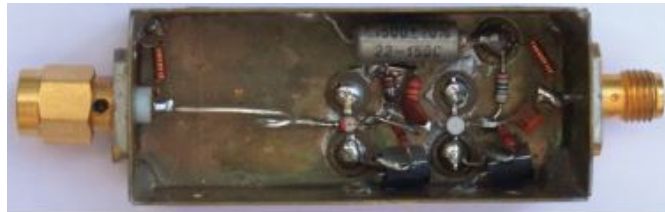
Figura 5.14: Ejemplo de LNA empleado en [SV].
