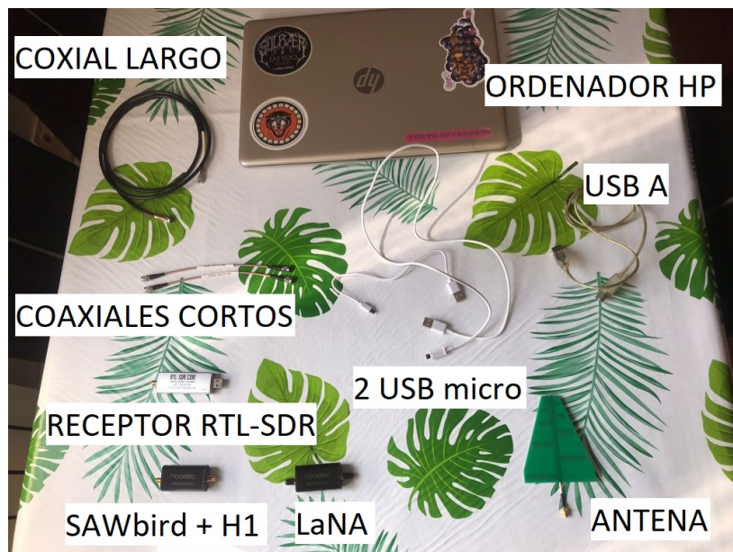
Figura 5.55: Componentes usados para el montaje del SRT.
