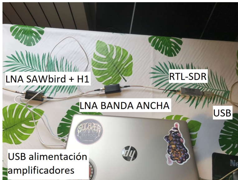
Figura 5.67: Electrónica del nuevo SRT con el amplificador adicional de banda ancha (LaNA).
