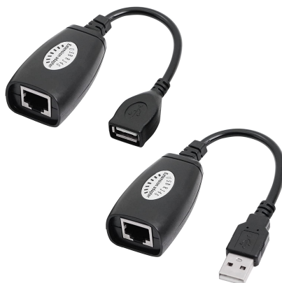
Figura 5.37: Adaptador Ethernet a USB 2.0 efectivo hasta 45-50 metros de distancia.
