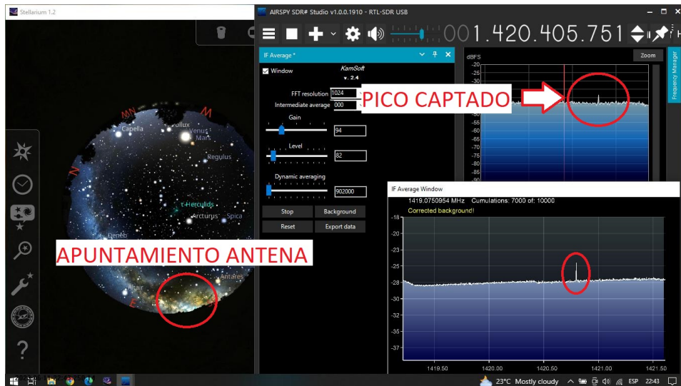
Figura 5.64: Captación de un pico de RF cercano a la frecuencia del hidrógeno desde San Ignazio, Bilbao.
